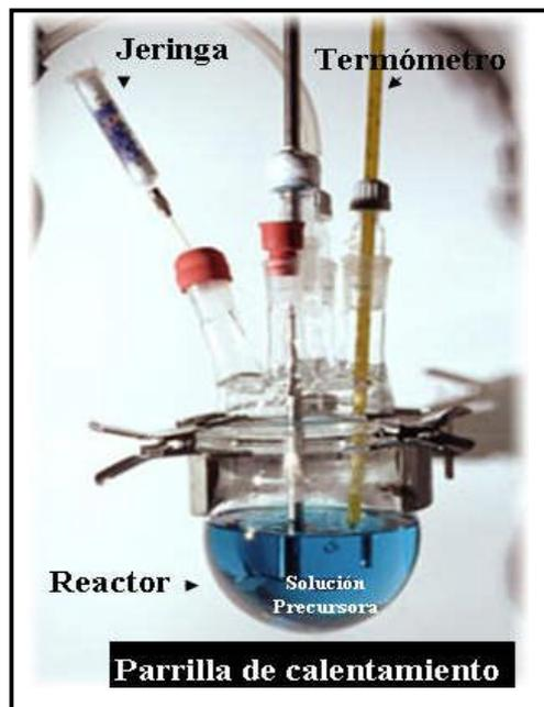
**Figura 2.3:** Arreglo experimental para la síntesis de dispersiones coloidales de nanopartículas metálicas.
