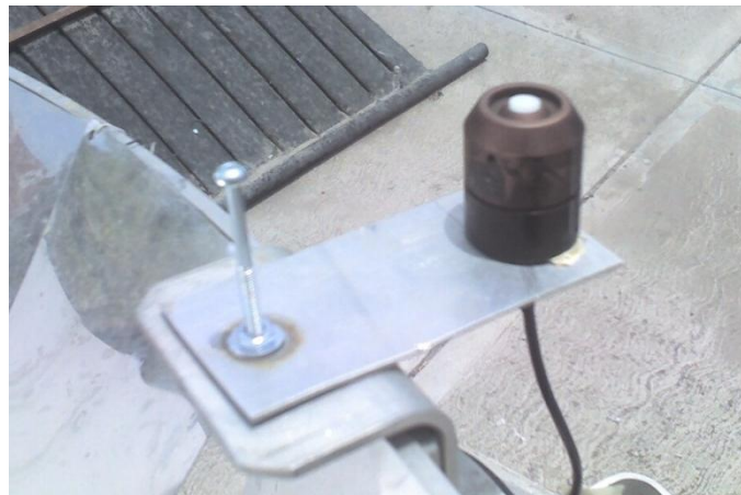
Ilustración 3-5 Colocación del piranómetro en el concentrador solar SK-14
