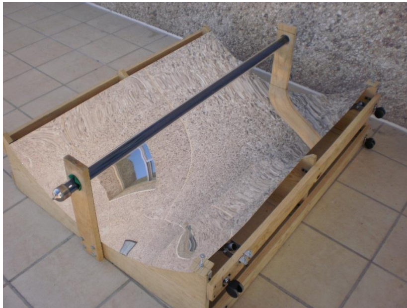
Ilustración 3-56 Concentrador con tubo evacuado
