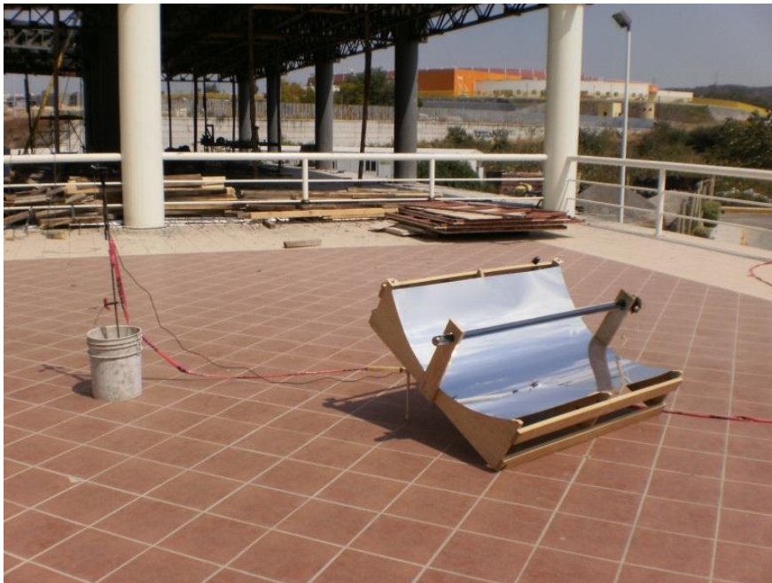
Ilustración 3-57 concentrador solar orientado al sur con inclinación de 32°
