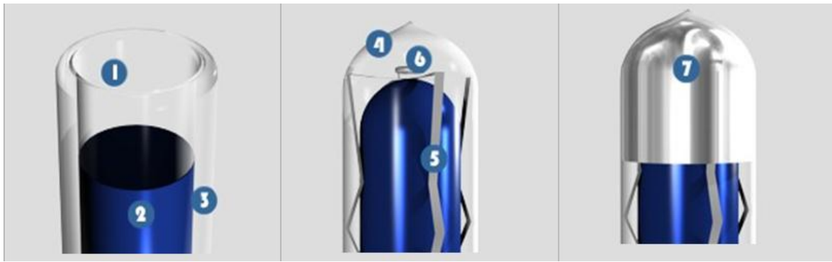
Ilustración 2-13 Diagrama de componentes del tubo evacuado
