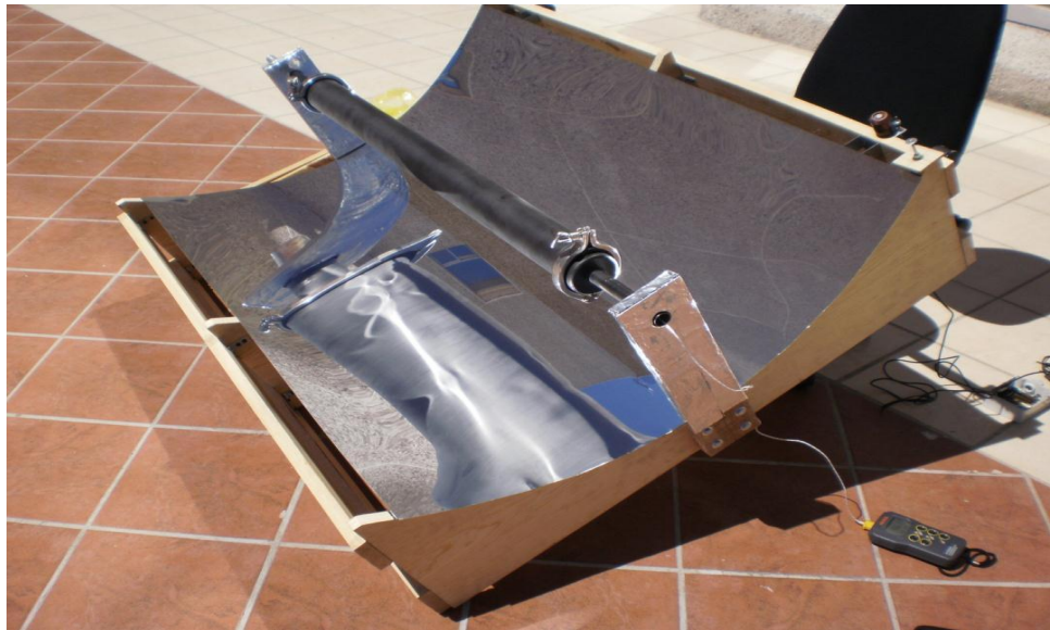
Ilustración 3-51 Prueba de temperatura con tubo de acero inoxidable
