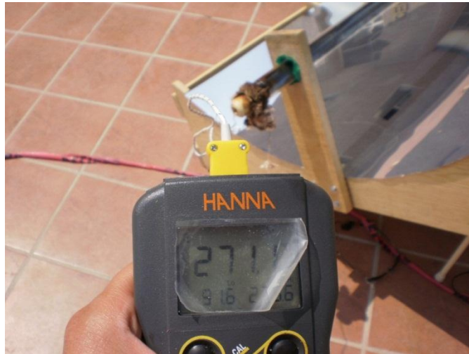
Ilustración 3-58 Medición de temperatura interna del tubo
