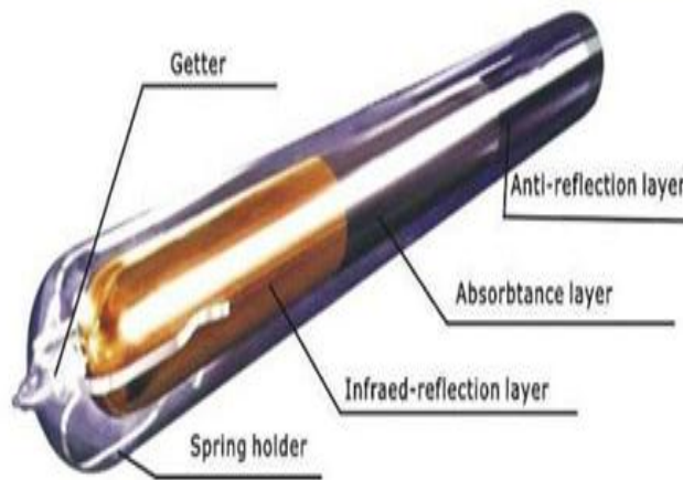
Ilustración 2-12 Esquema del tubo evacuado tricapa
