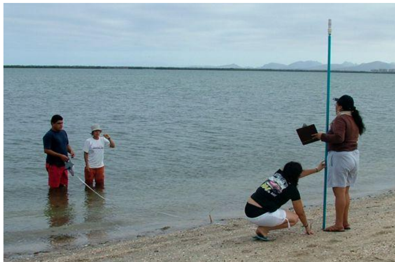
Figura 4.- Medición de la pendiente en cara de la playa en El Conchalito.
