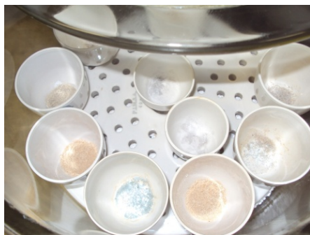
Figura 39. Muestras incineradas, las diferencias en la coloración se deben a presencia de minerales.
