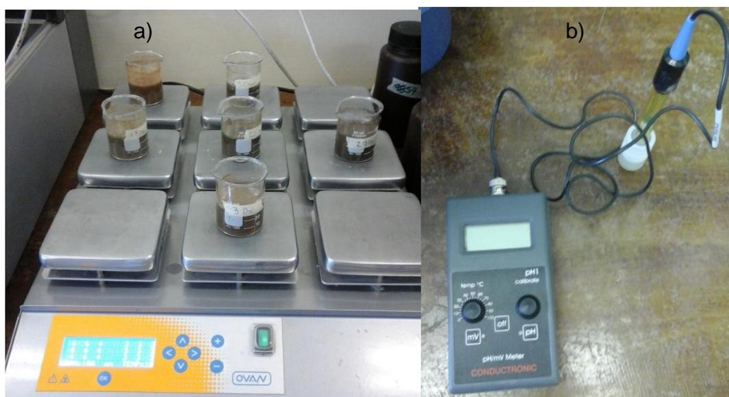
Figura 11: a) Agitación magnética en parrillas, b) Potenciómetro
