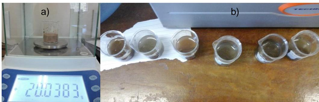
Figura 10: a) Pesado de 20g la muestra, b) Mezcla 1:1 de agua desionizada y suelo.
