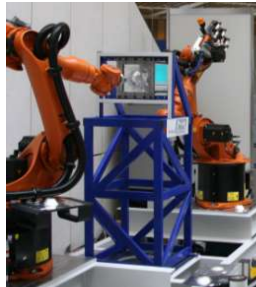
Figura 2.7 Vista posterior del sistema Roboforming durante la demostración del embutido de una pieza simple (fuente: [a])
