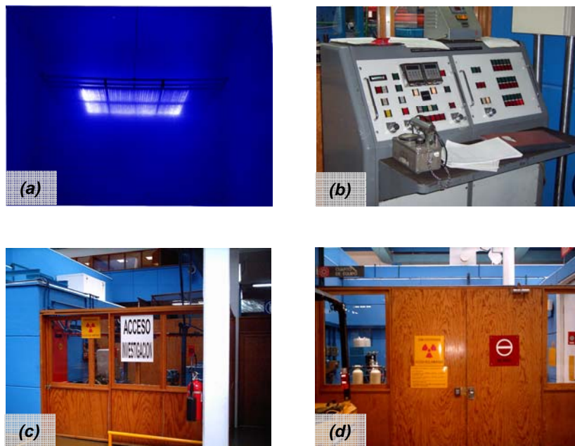
Figura 3.6. (a) Fuente de cobalto 60, (b) Consola de control, (c) área de acceso de investigación (d) puerta de acceso al irradiador JS-6500 y al cuarto de control Irradiador Gamma, ININ. México, 2006.
