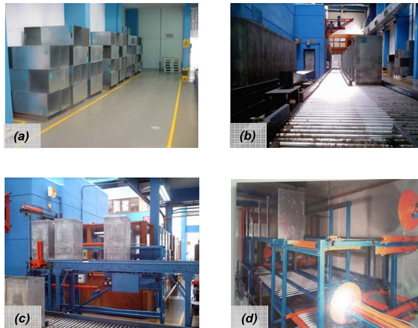
Figura 3.5 (a) Contenedores de aluminio, (b) Cama de rodillos, (c) sistema de transporte a la entrada de la cámara de irradiación, (d) contenedores en el interior de la cámara de irradiación. ININ, 2006
