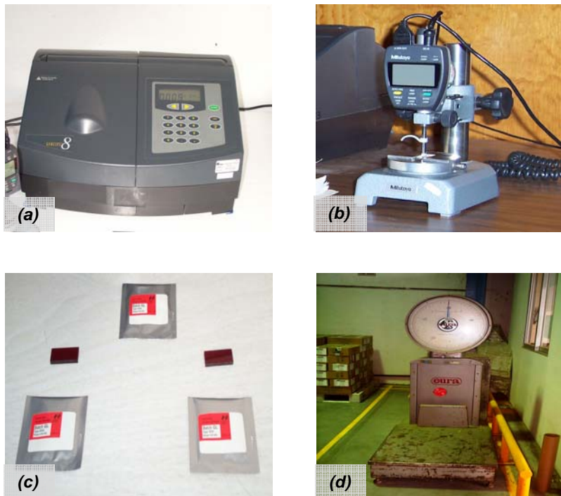
Figura 3.7. (a) Espectrofotómetro Genesys 8, (b) Indicador digital (c) Dosímetros, (d) Balanza semiautomática en el laboratorio de dosimetría y almacén del Irradiador Gamma, ININ. México, 2006.
