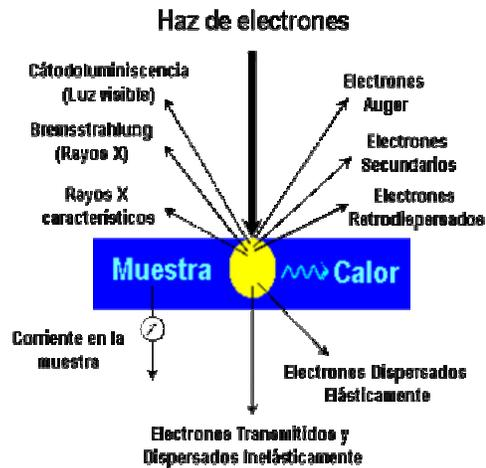
Figura 2.4. Interacción del haz de electrones con la muestra.
