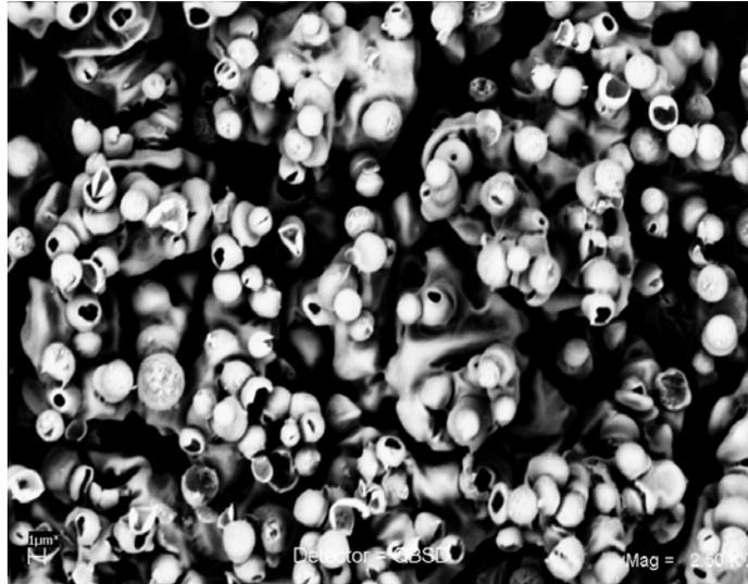
**Figura 4.7.** Micrografía obtenida por MEB para la película de  $\text{HfO}_2:\text{Sm}^{+3}$  (3 a/o) depositada a una temperatura de sustrato de  $550\text{ }^\circ\text{C}$ . Amplificación de  $2500\times$ .
