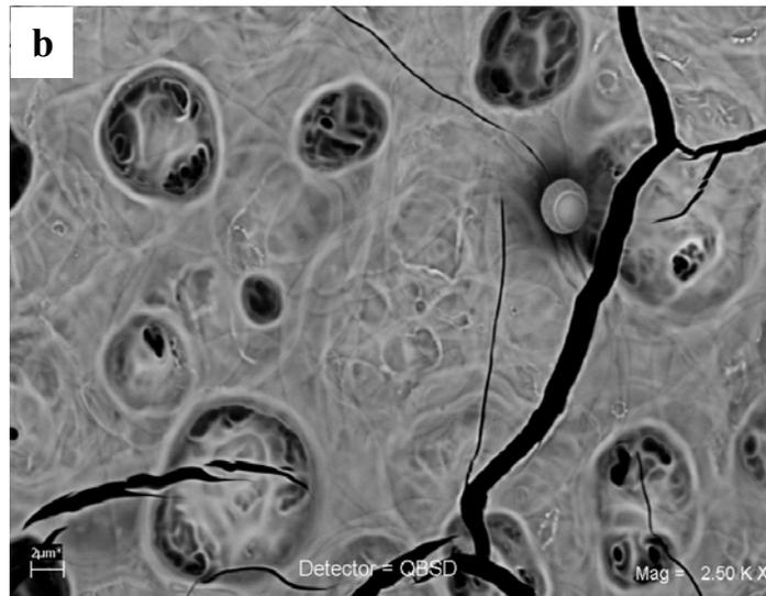
**Figura 4.3.** Micrografías obtenidas por MEB para la película de  $\text{HfO}_2:\text{Sm}^{+3}$  (3 a/o) depositada a una temperatura de sustrato de 300 °C. (a) amplificación de 1000x. (b) amplificación de 2500x.
