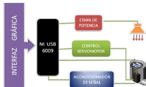
Fig. 1 Configuración experimental de la técnica de calorimetría con excitación luminosa variable en el tiempo.
