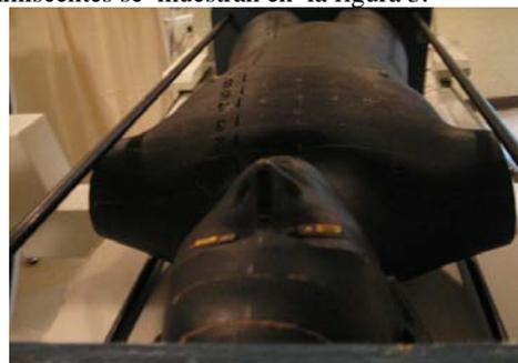
Figura 2. Colocacion de dosímetros en cristalino y superficie
