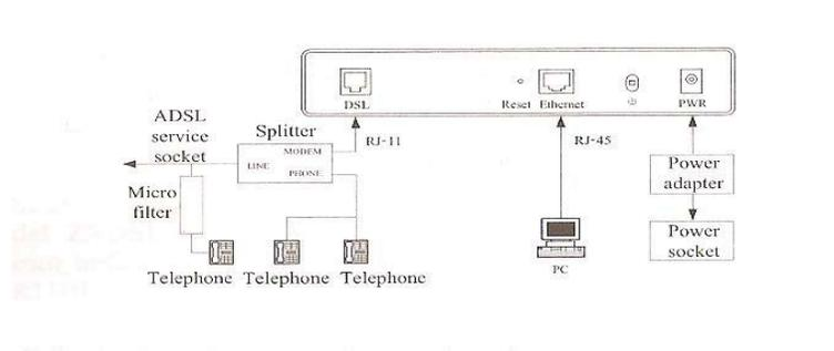
**Figura 72: Esquema de conexión de un modem<sup>33</sup>**
