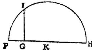
**Figura 46:** Método geométrico para extraer la raíz cuadrada<sup>42</sup>
