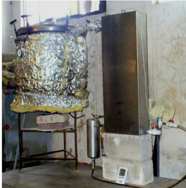
**Figura 6.** Prototipo de extracción de aceite esencial
