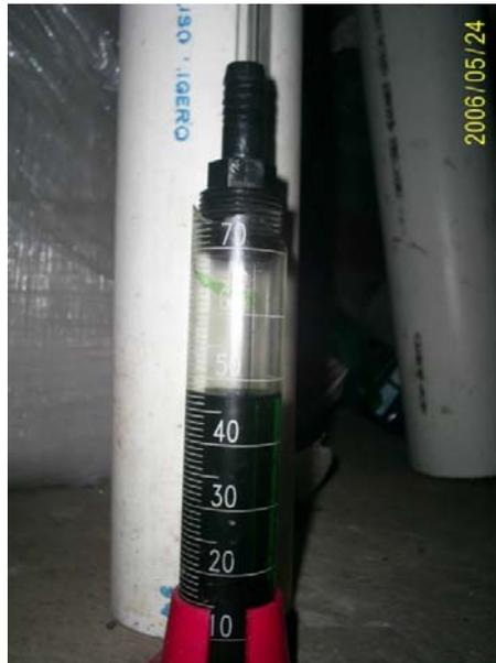
**Figura 7.** Medidor del vacío mediante columna de alcohol
