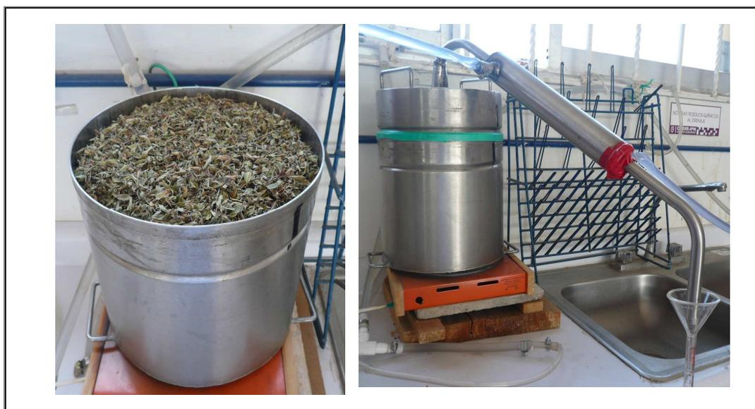
**Figura 11.** Equipo utilizado para extraer el aceite esencial
