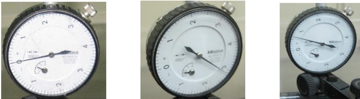
Fig. 4 3 En la figura 4.3 a) indicador de caratula calibrado a cero figura 4.3 b) amplitud máxima en la medición del doblamiento del eje (11.1 mils) antes de proceso de desdoblamiento 4.3 c) amplitud máxima después del proceso de desdoblamiento. (0.6 mils)
