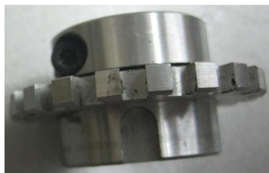
fig 3. 4 Pieza elaborada para medición de Revoluciones y keyphasor.
