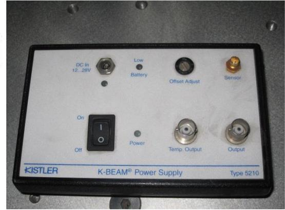
fig 3. 12 Sensor de aceleración 8305A2M4 marca Kistler®- Acondicionador de señales K-BEAM® modelo 5210 marca kistler ®
