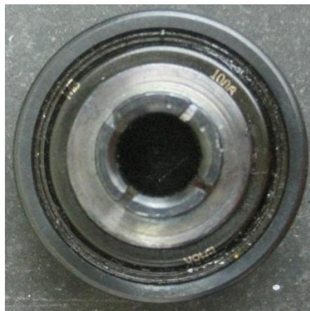
fig 3. 6 Rodamientos adquiridos que permiten un mayor rango en su velocidad de operación.
