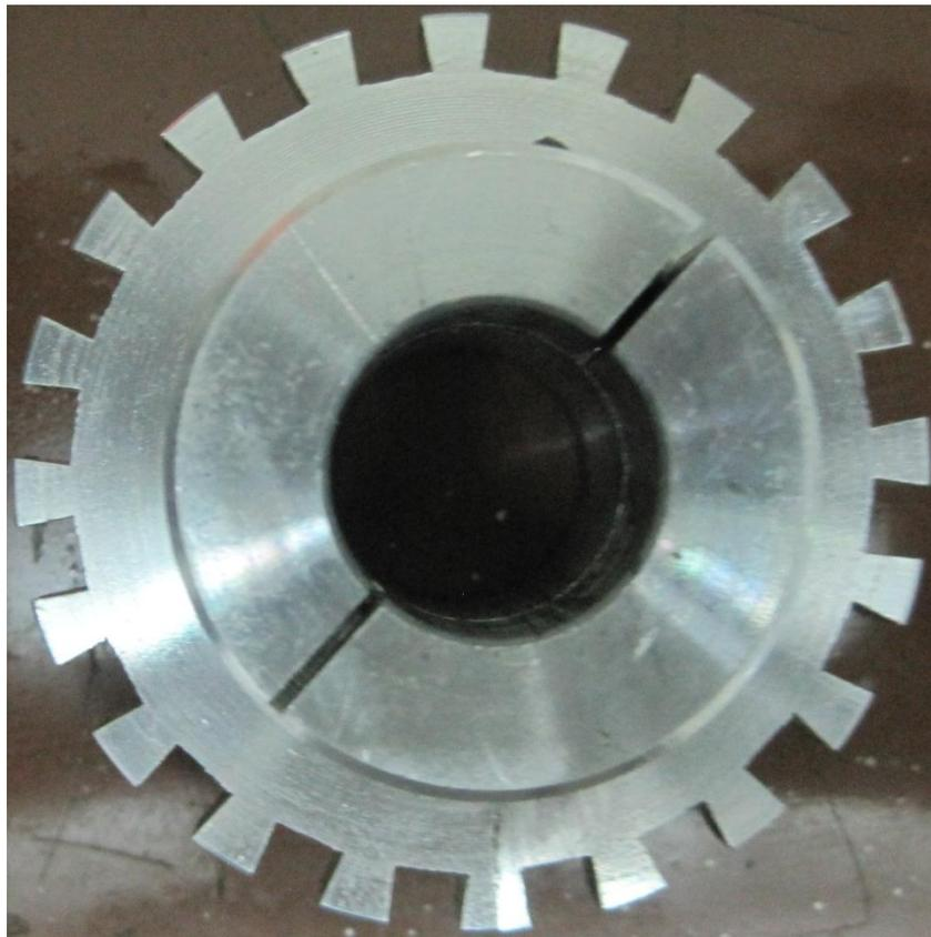
fig. D. 8 pieza para adaptación para tacómetro y keyphasor
