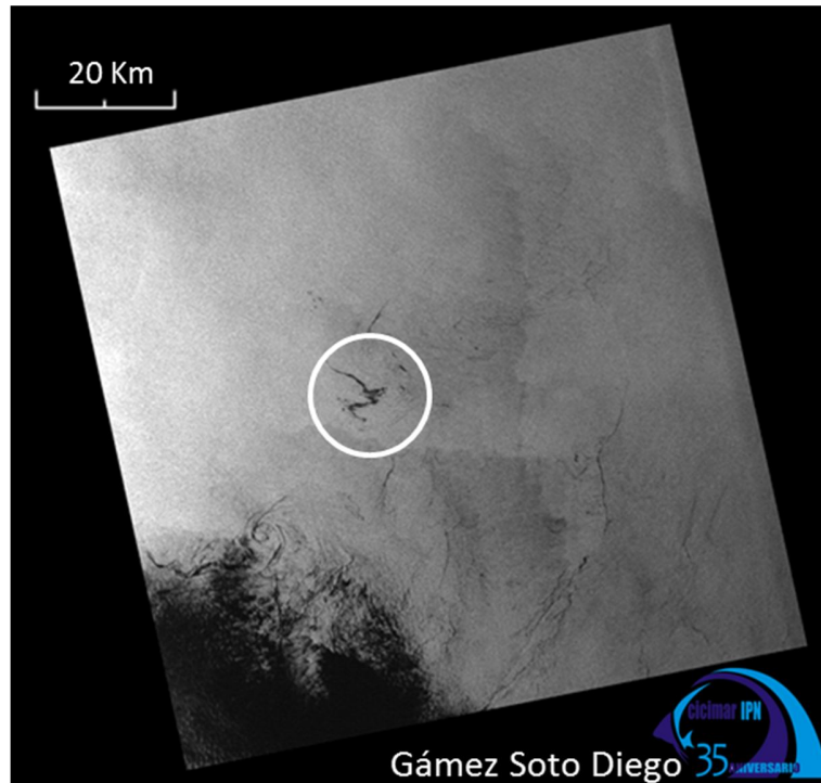
Figura 55. Cálculo \sigma^0 en la imagen SAR del 7 octubre 07O233347100405 (cuadro g). Chapopotera de 20 km encerrada en el círculo.
