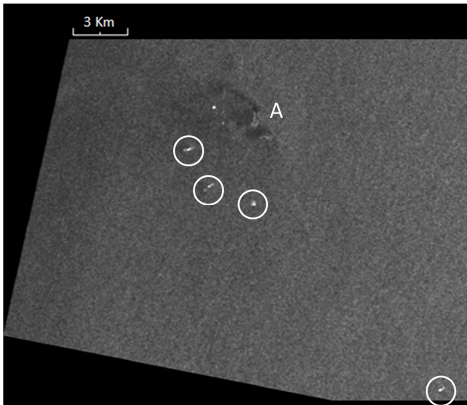
Figura 47. Subimagen 16O2344114103195. Detección de Cayo Arcas y cuatro barcos petroleros.
