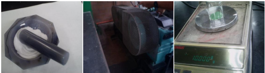
Figura 6. (a) Fotografía \text{SiO}_2 molido en mortero de ágata. (b) \text{FeS}_2 en molino de rodillos. (c) balanza analítica
