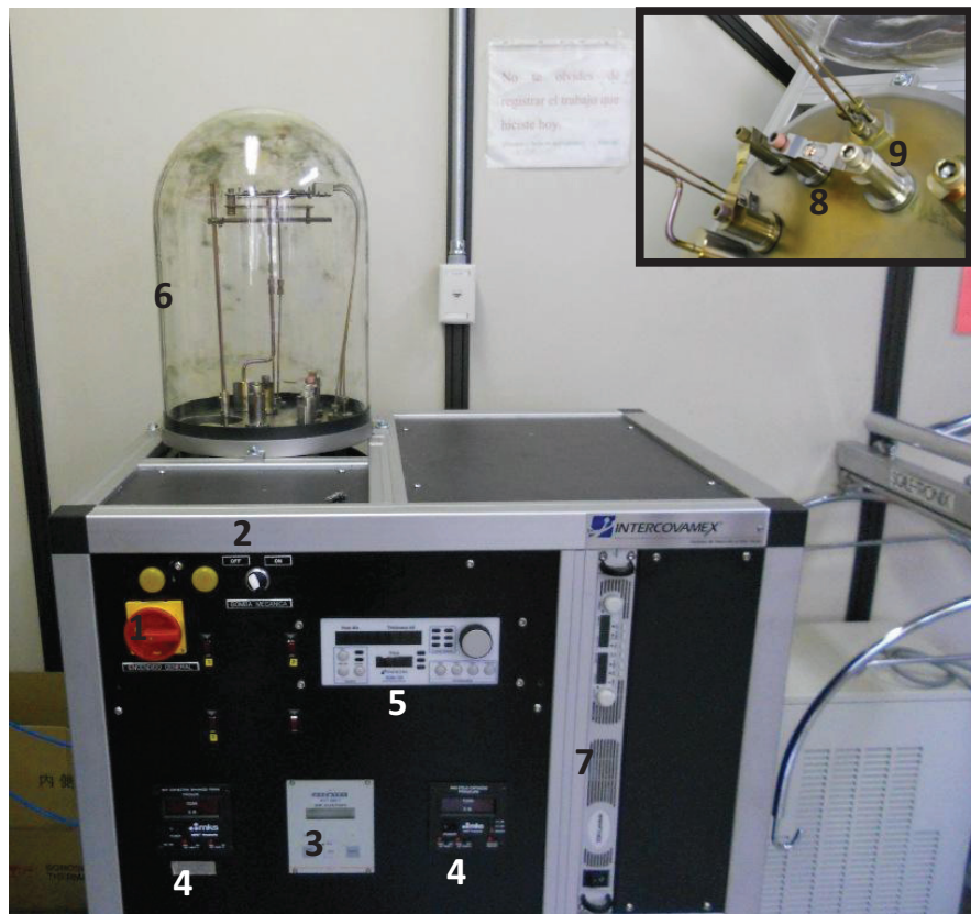
Figura 3-3. Sistema de evaporación al vacío empleado para el depósito de cobre.
