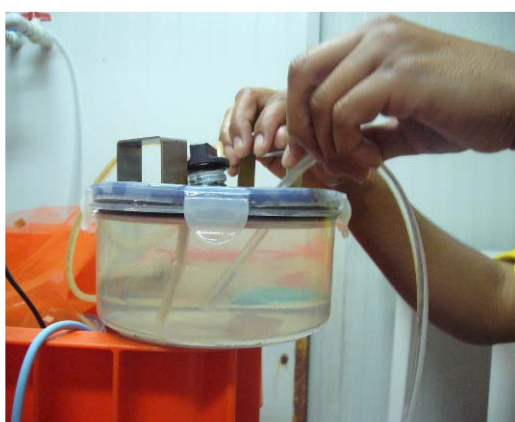
Figura 12. Cámara respirométrica con sistema de flujo continuo, para evaluar las tasas fisiológicas utilizadas del camarón blanco L. vannamei .
