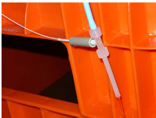
Figura 10. Sensor de oxígeno de fibra óptica (microoptode) del oxímetro Microx TX, colocado a una manguera con flujo continuo para las determinaciones del oxígeno disuelto de los tanques de los tratamientos.
