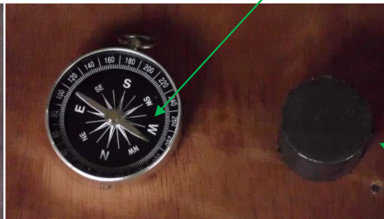
Figura 3. 2 Brújula afectada por el campo magnético de un imán
