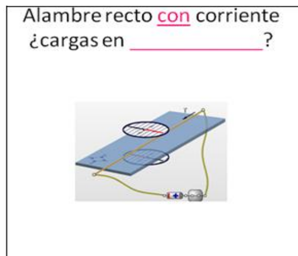
Figura 3. 8 Experimento de Oersted con pantalla 6 adaptada
