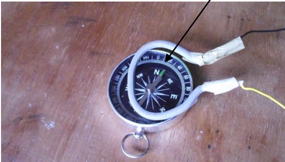
Figura 3. 4 Brújula afectada por el campo magnético de la espira
