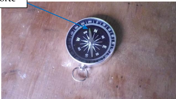
Figura 3. 2 Brújula afectada por el campo magnético de un imán
