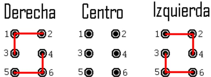
Posiciones de conexión de un interruptor de tambor Trifásico AG3
