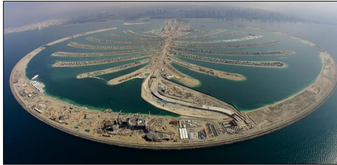
Figura 21. Jabel Ali. Es la segunda isla artificial en forma de palmera en Dubái, EAU. Se encuentra en el distrito de Jabel Ali. Tiene un área de 8.4 km 2 y se conecta a tierra por medio de tres puentes.
