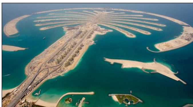
Figura 20. Palm Jumeirah, en Duái, EAU. Es una de las islas artificiales más grandes del mundo. Tiene una forma de palmera representativa de la región hecha tan solo de arena y protegida por un gran rompeolas que la protege de las condiciones climáticas.
