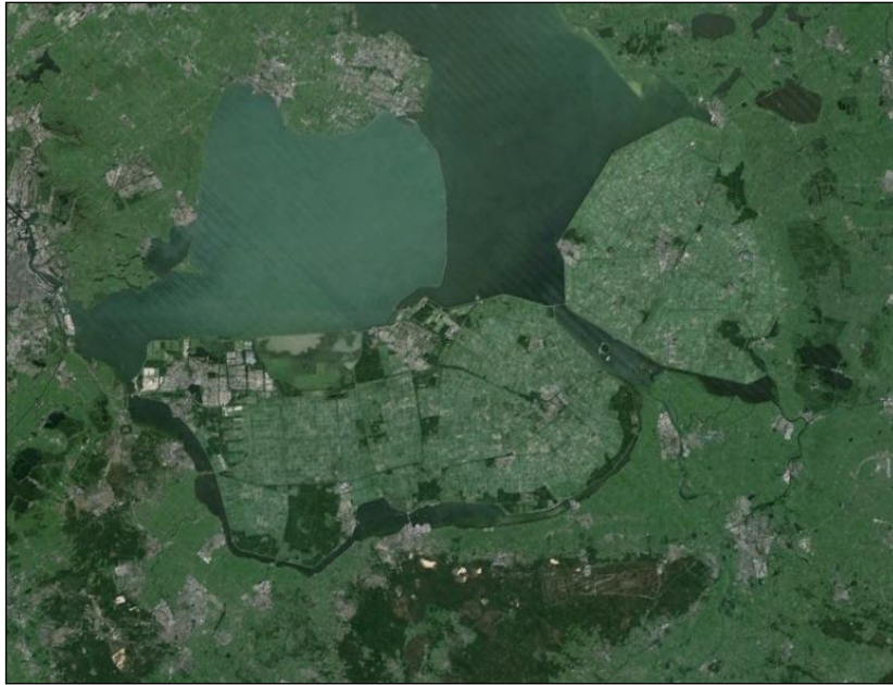
Figura 3. Flevoland. Forma parte de los llamados Países Bajos que se caracterizan principalmente por sus terrenos ganados al mar mediante pólderes. Esta técnica se usó por primera vez en el siglo XII y consistía en una serie de diques que protegían a las tierras bajas que se encontraban al nivel del mar o más bajas aun, drenándolas por medio de un sistema de bombeo y así poder explotar el terreno con fines agrícolas e industriales.
