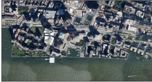
Figura 5. Battery Park City. Se encuentra en el suroeste de Manhattan, Nueva York, con un área de 0.4 km 2 que se levantó ganándole terreno al río Hudson, usando 917,000 m 3 de tierra y rocas provenientes de la excavación del World Trade Center (Russell, 1994).
