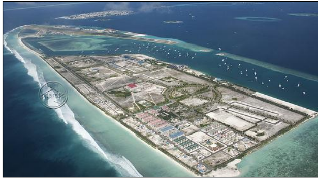
Figura 12. Hulhumalé. Es una isla artificial que posee una superficie 2.0 km 2 localizada en el atolón de Kaafu, Republica de Maldivas. Fue construida con el fin de establecer una nueva porción de tierra con la capacidad de albergar la expansión de la región de Malé en lo que a términos de desarrollo inmobiliario, industrial y comercial se refiere.
