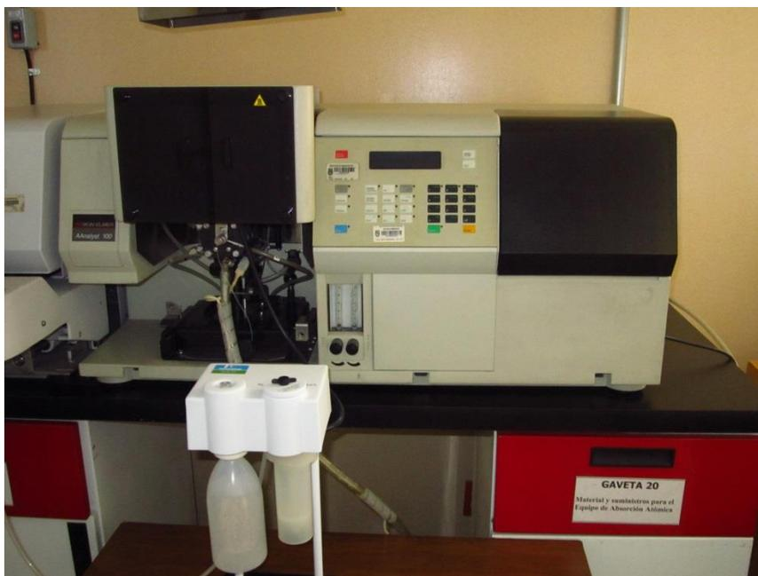
**Figura 3.** Espectrofotómetro de absorción atómica por generación de hidruros.
