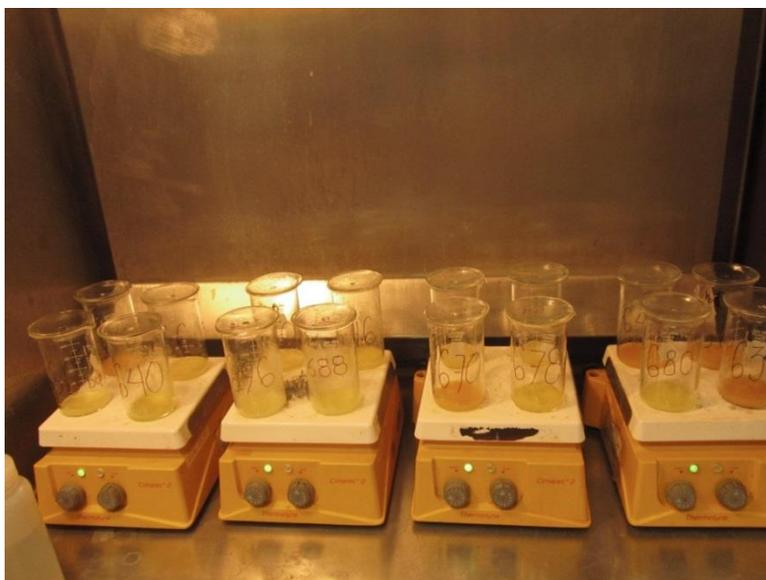
**Figura 2.** Digestión por calentamiento en placa.
