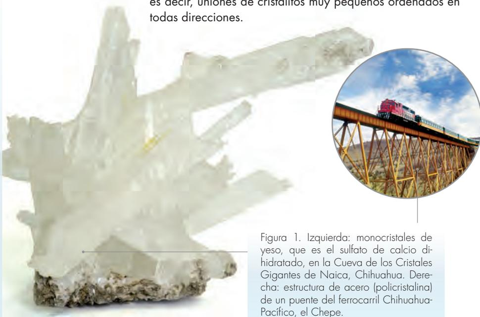
Figura 1. Izquierda: monocristales de yeso, que es el sulfato de calcio dihidratado, en la Cueva de los Cristales Gigantes de Naica, Chihuahua. Derecha: estructura de acero (policristalina) de un puente del ferrocarril Chihuahua-Pacífico, el Chepe.
