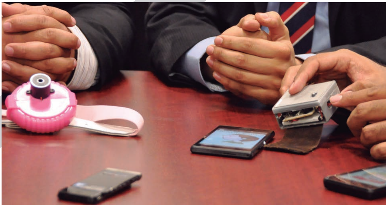
► El mecanismo de Child Alert está compuesto por microcontroladores, módulos bluetooth y una batería que tiene una duración aproximada de 72 horas de uso continuo
