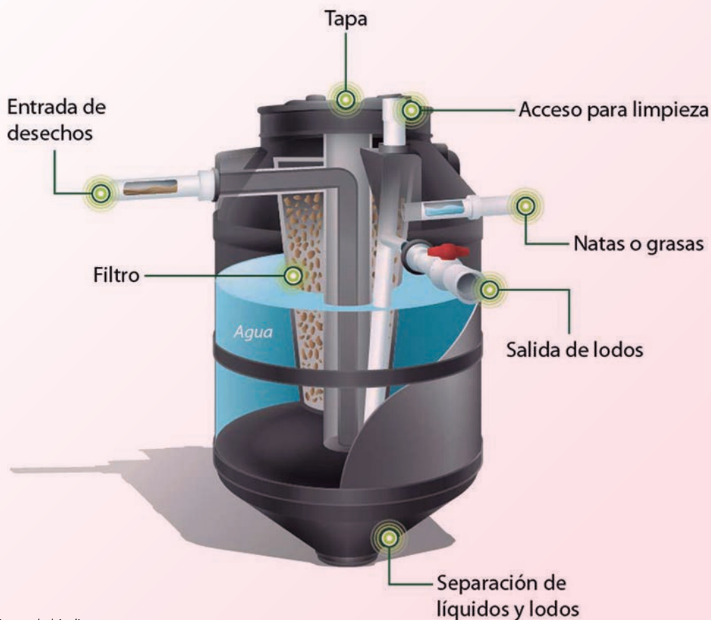
► Funcionamiento de biodigestor
