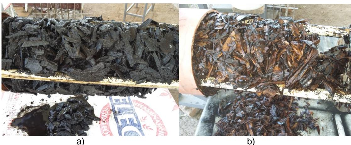
Figura 12. Vista del material filtrante orgánico después de 15 meses de operación, a) BF con aire, b) BF sin aire.
