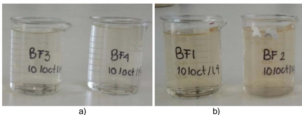
Figura 25. Efluentes de los biofiltros empacados con astillas de madera de mezquite como medio soporte a una CHS de  $1.07 \text{ m}^3 \text{ m}^{-2} \text{ d}^{-1}$ , a) BFs con aire b) BFs sin aire
