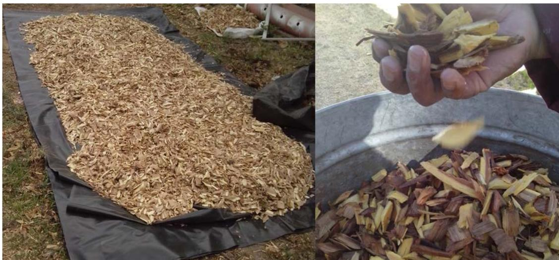
Figura 11. Astillas de madera de mezquite empleadas como material filtrante orgánico (MFO) en el sistema de biofiltros
