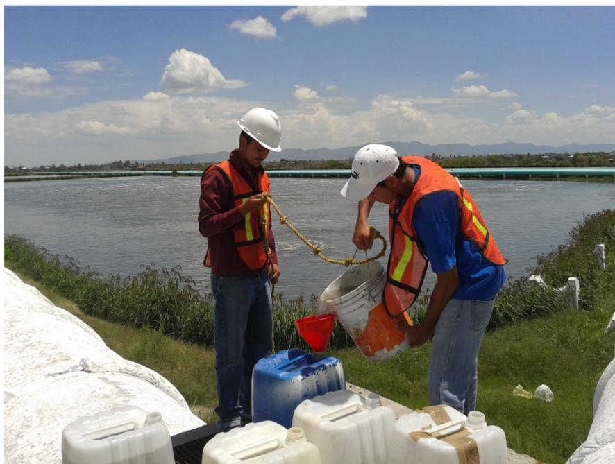
Figura 8. Toma de muestra de agua residual de la PTAR oriente del municipio de Durango
