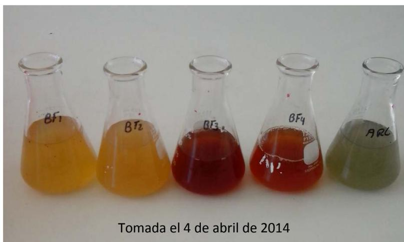
Figura 13. Efluentes de los biofiltros empacados con astillas de mezquite BF1-2 sin aire y BF3-4 con aire.
