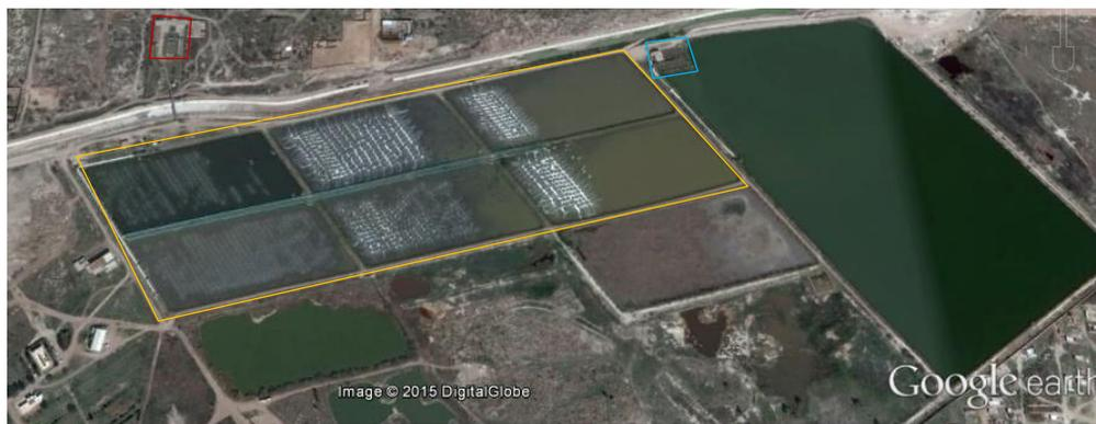
Figura 10. Vista aérea de la PTAR sector Oriente de Durango, México. Cribado (-), Lagunas de oxidación (-) y cloración (-).
