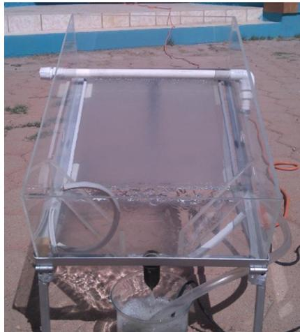
Figura 12. Fotorreactor solar de placa plana empleado para la inactivación de coliformes fecales.
