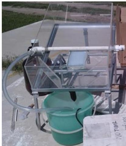
Figura 13. Fotorreactor solar de placa plana (0.125mx0.08m), para la actividad fotocatalítica de  $\text{TiO}_2$ .
