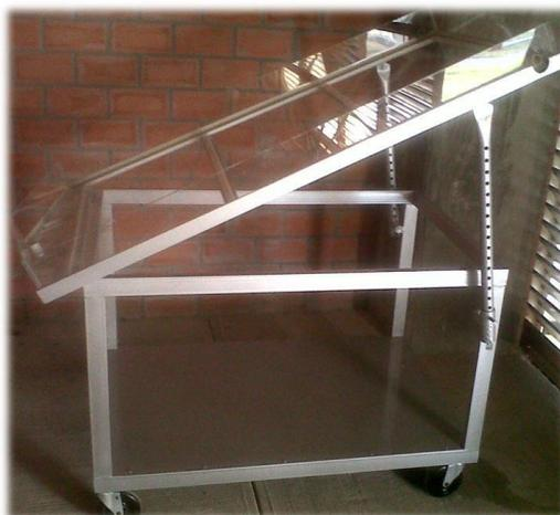
Figura 14. Fotorreactor solar de placa plana (1.25mx0.8m), para la degradación de 2,5-Diclorofenol.
