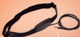
**Acelerómetro de triple eje** se coloca en la cintura para detectar posición del usuario y sus movimientos.
