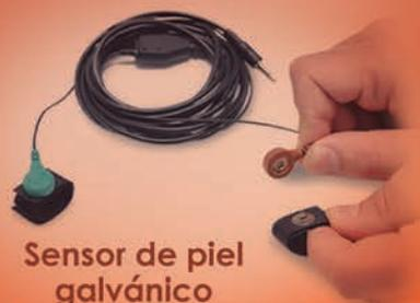
**Sensor de piel galvánico** también se localiza en la parte interna del chaleco, adhiere sus dos contactos en la parte interna de dos dedos de la mano detectando niveles de sudoración por estrés.
