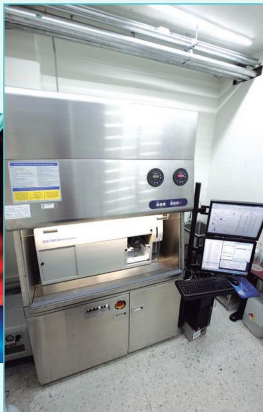
👍 El citofluorómetro de flujo FACSria Fusion especifica el tipo de cáncer a través de una muestra de sangre o biopsia en menos de tres minutos
