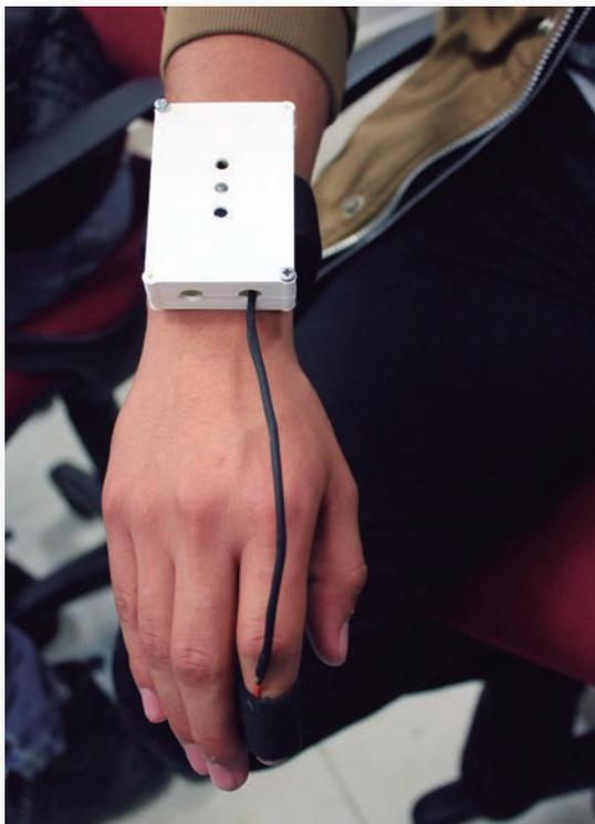
👍 MANS funciona al colocar el pulsímetro en el dedo índice y el gadget que contiene la pantalla se pone en la muñeca para monitorear los niveles de sudoración, respiración y flujo sanguíneo
