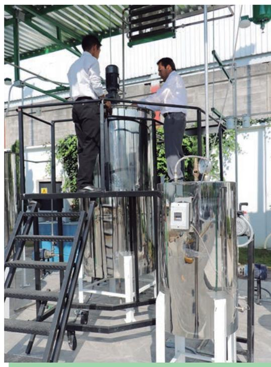
👍 Esta planta de biodiésel procesa 500 litros diarios con un bajo consumo de energía y no genera residuos que dañan al ambiente
