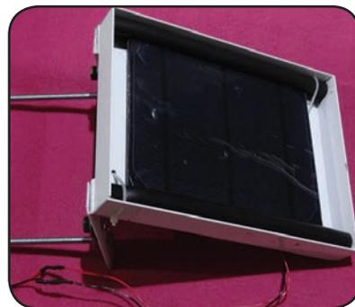
Tapa del prototipo con celda solar
