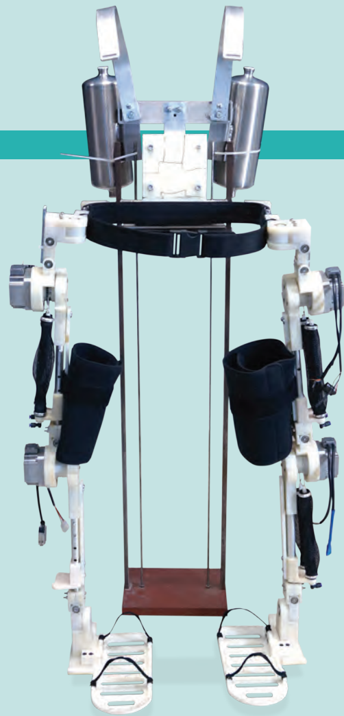
► El exoesqueleto de bipedestación posiciona de manera vertical a personas que permanecen todo el tiempo en silla de ruedas
