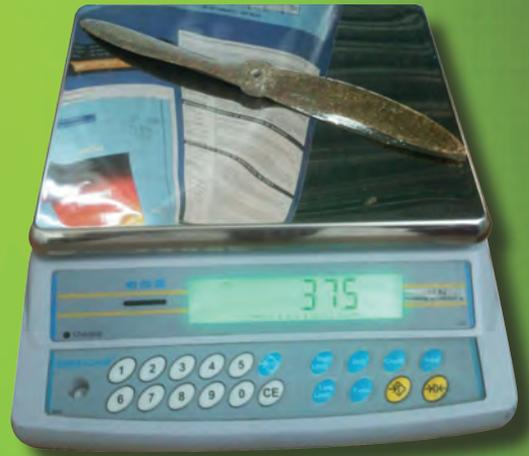
👍 El primer paso fue modificar el perfil de una hélice comercial mediante un software especial, posteriormente a partir del diseño de la optimización imprimieron una hélice en 3D
