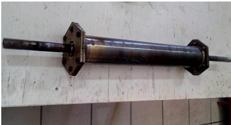
*Figura 17: Reactor para calcinado.*
