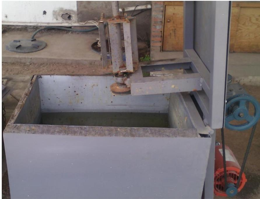
*Figura 16: Sistema de agitación con temperatura constante.*
