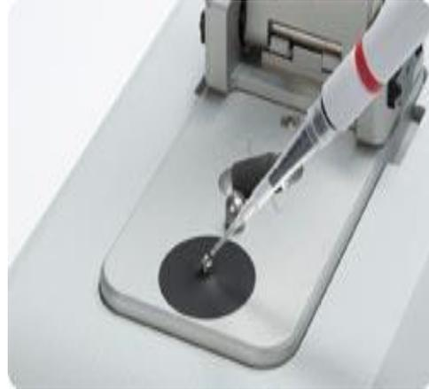
**Figuras 18 y 19. Placa del Nanodrop para agregar 1  $\mu\text{L}$  de ADN en la ranura del Pozo del Equipo.**
