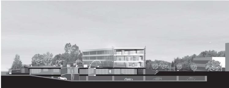
Corte longitudinal en estacionamiento subterráneo de la propuesta del edificio anexo.
