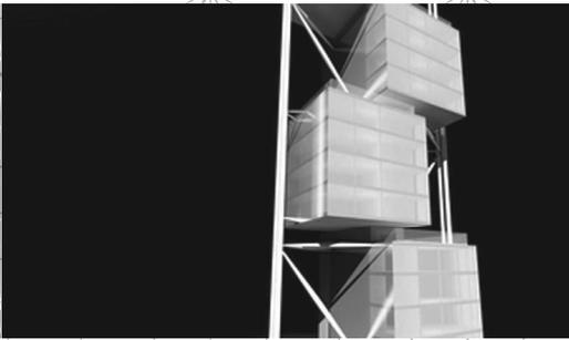
Figura 5. Proyecto Torre Sur de Nueva York, del arquitecto Calatrava, edificación conformada de cubos habitacionales sujetos sobre un poste principal, el cual ayuda a estabilizar la forma del edificio.
