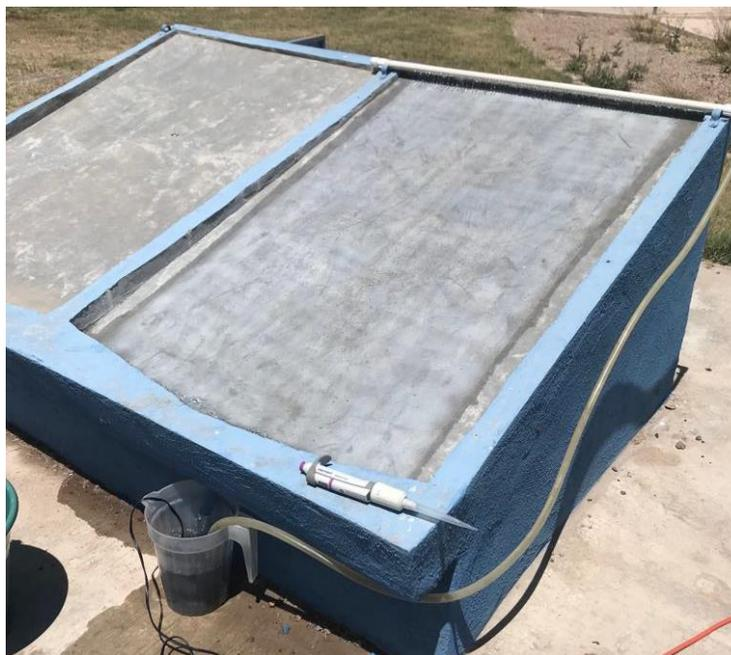
**Figura 24.** Estructura del reactor fotocatalítico de concreto para procesos de fotólisis y fotocátalisis con radiación solar natural.
