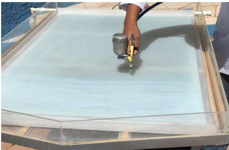
**Figura 7.** Impregnación de TiO<sub>2</sub> en placa de vidrio esmerilado por aspersion directa.
