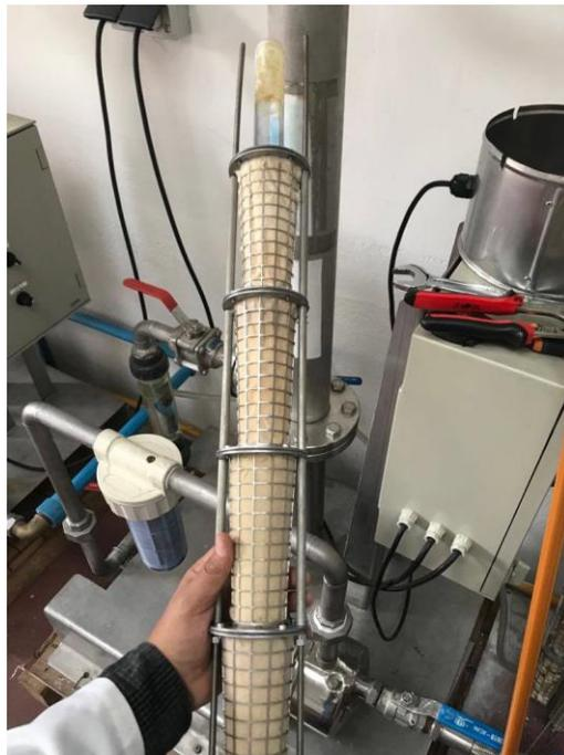
**Figura 9.** Soporte catalizador  $\text{TiO}_2/\text{SiO}_2$
