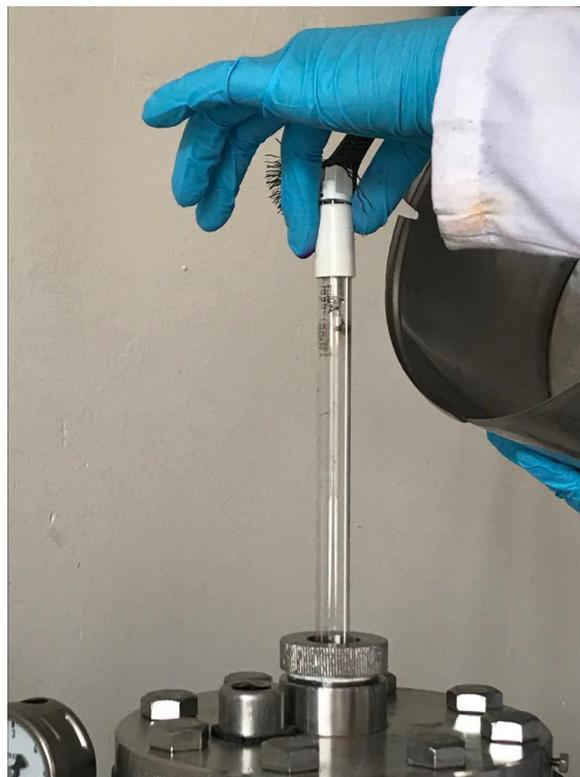
**Figura 6.** Lámpara para radiación UV.
