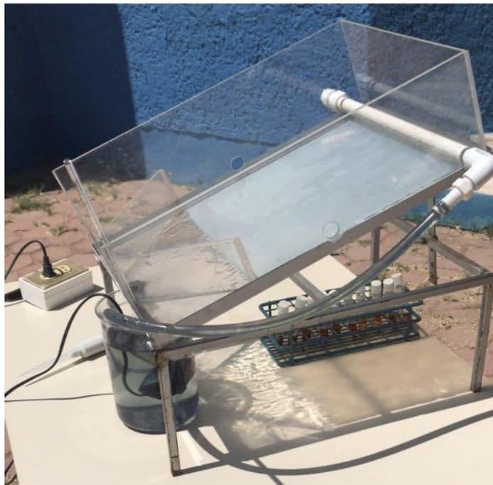
**Figura 4.** Reactor de cama dura 1/10 m<sup>2</sup>.
