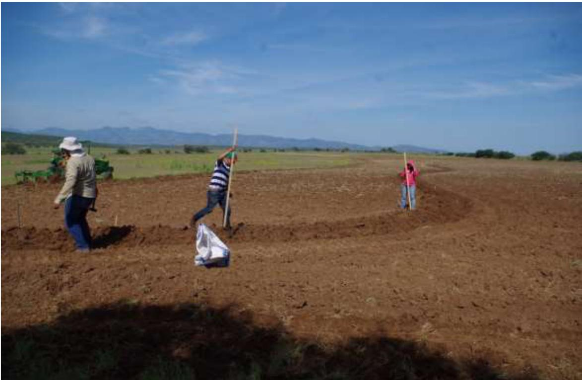
**Figura 4. Levantamiento topográfico con manguera de nivel**
