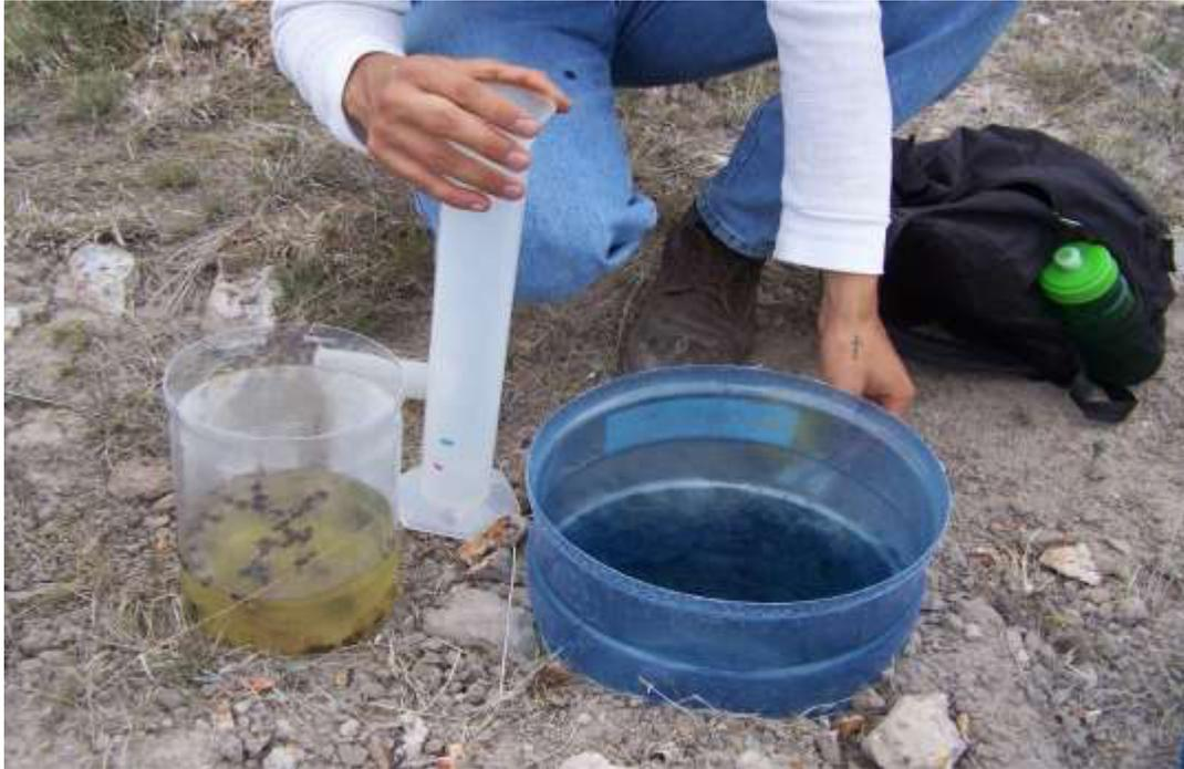
Figura 11. Instalación de pluviómetro contiguo a la parcela para el registro de precipitación en el área de estudio.
