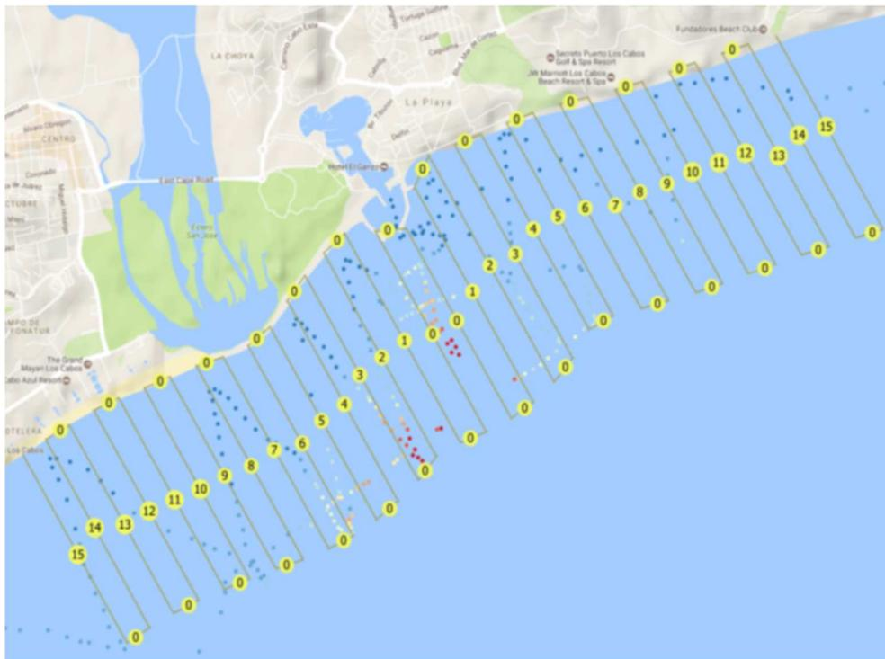
**Figura 9.** Trayectoria para el levantamiento batimétrico definida en QGIS.
