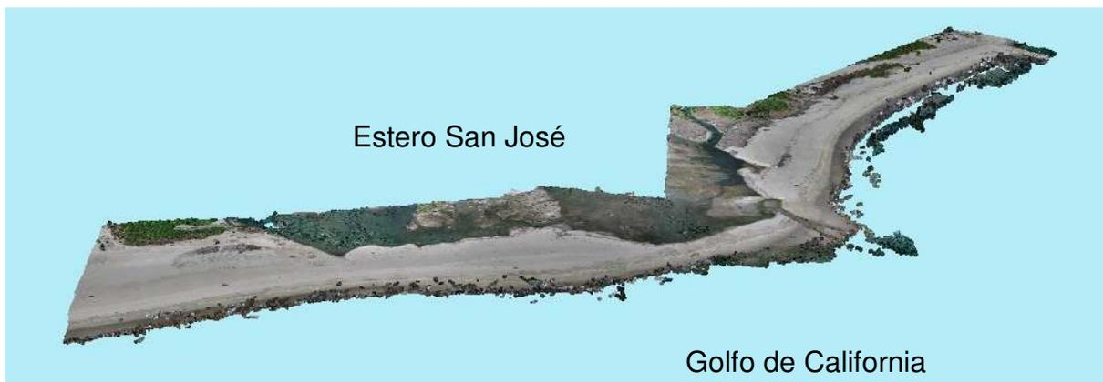
**Figura 5.** Nube de puntos generada con el software Agisoft Photoscan (levantamiento del 15/feb/2018).
