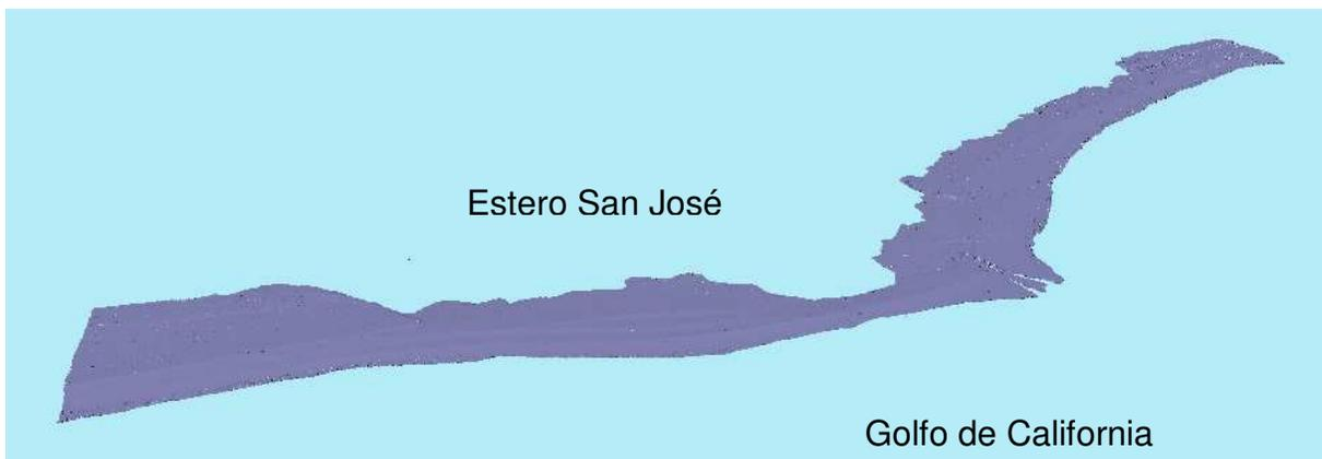
**Figura 7.** Malla que representa la superficie del terreno generada por la triangulación de la nube de puntos clasificada (levantamiento del 15/feb/2018).
