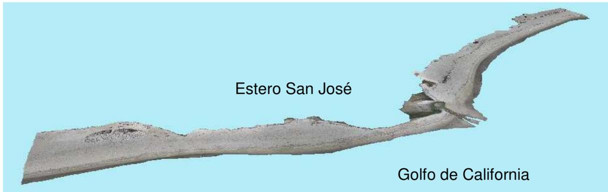
**Figura 8.** Modelo digital del terreno (MDT) texturizado con los valores RGB de las fotografías procesadas (levantamiento del 15/feb/2018).
