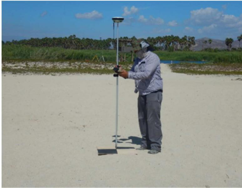
**Figura 4.** Georreferenciación de puntos de control con equipo GNSS Leica Viva Gs14.
