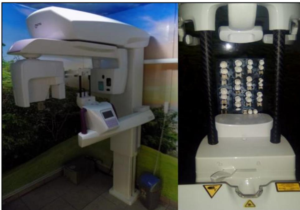
**Figura 9.** Izquierda: Equipo de tomografía computarizada HYPERION modelo X9. Derecha: Vértex de *C. ventriosum* sobre la tarjeta en el área de escaneo.
