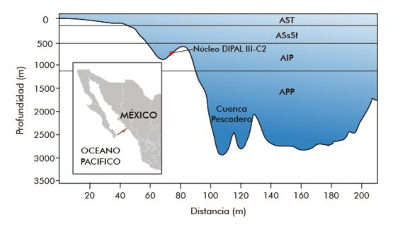
Figura 1. Perfil batimétrico de la región sur del Golfo de California donde se observa el sitio donde se obtuvo el núcleo de sedimento utilizado en el presente estudio (símbolo de estrella) y la distribución vertical de los tipos de agua. AST= Agua Superficial Tropical; ASsSt= Agua Subsuperficial; AIP= Agua Intermedia del Pacífico; APP= Agua Profunda del Pacífico.
