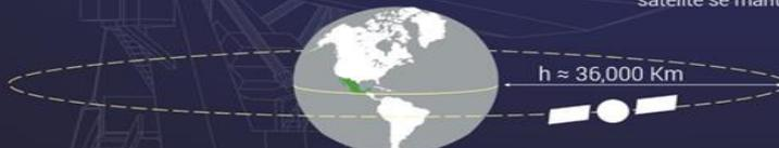
La órbita geoestacionaria al ser un círculo cuenta con 360 grados ( $^{\circ}$ ); los cuales están divididos en  $180^{\circ}$  Longitud Oeste (O) y  $180^{\circ}$  Longitud Este (E). El arco geoestacionario útil para prestar servicios en México se encuentra ubicado entre los  $40^{\circ}$  y los  $160^{\circ}$  de Longitud Oeste. Este segmento coincide con el arco útil para prestar servicios en los Estados Unidos de América y Canadá.
