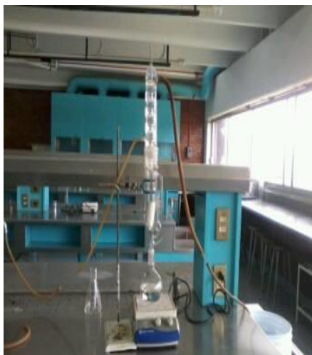
3. Sistema de extracción Soxhlet
