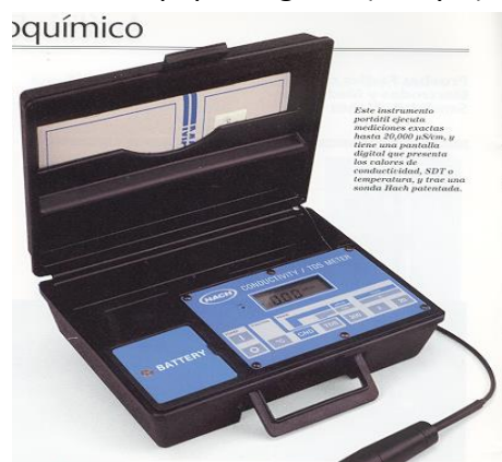
Fig. 3 ANÁLISIS ELECTROQUÍMICO Medidor Digital de Conductividad Eléctrica y de Sólidos Totales
