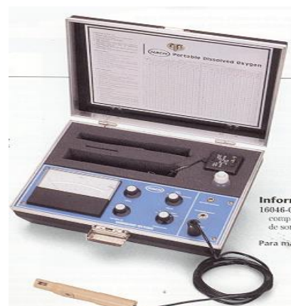
Fig. 4 MEDIDOR DE OXÍGENO DISUELTO Este equipo se utiliza para medir Contaminación, aireación y absorción de oxígeno en corrientes de agua
