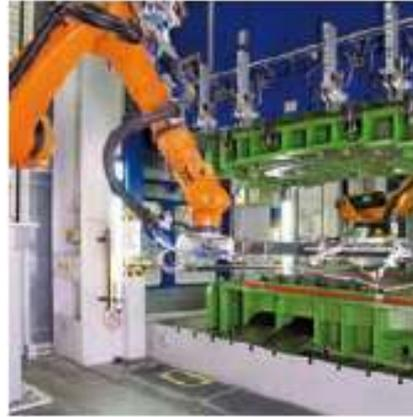
Figura 4. Línea automatizada de trabajo en prensa alimentada por robots (fuente: [http://www.schulergroup.com/de/10\\_Anlagen\\_Verfahren/01\\_Blechumformung/index.html](http://www.schulergroup.com/de/10_Anlagen_Verfahren/01_Blechumformung/index.html), 2-XI-2008)
