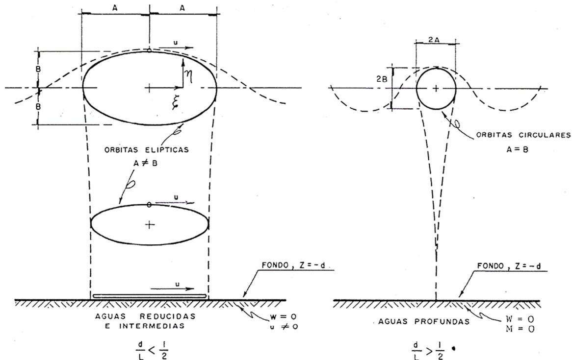
Figura 4. Desplazamientos de las partículas de agua; aguas profundas, intermedias y bajas. (USACE, 1984)
