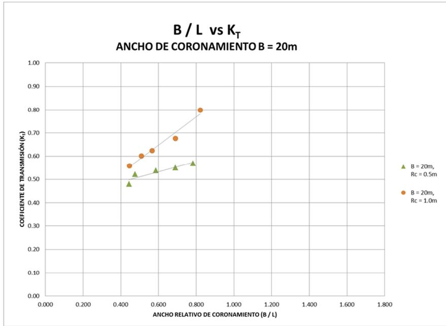
Gráfica 6. Ancho relativo de coronamiento vs  $K_T$ , para un ancho de coronamiento de 20 m.
