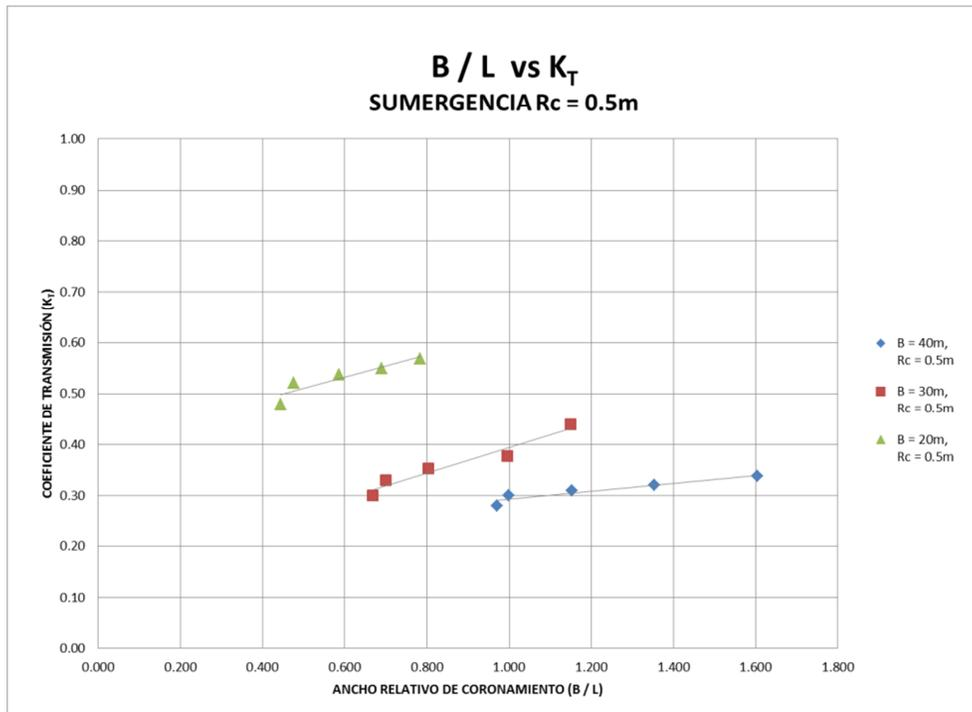
**Gráfica 9. Ancho relativo de coronamiento vs  $K_t$ , para una sumergencia de 0.5 m.**
