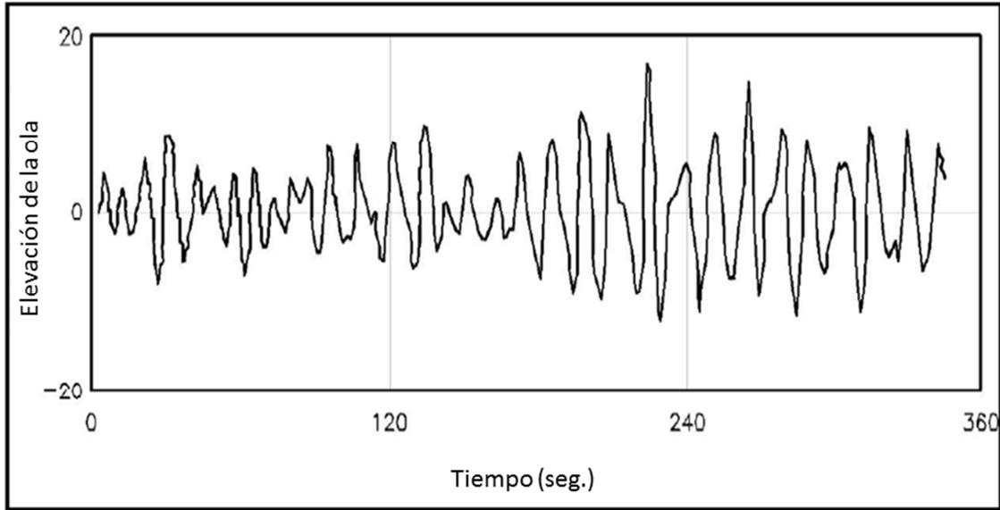
Figura 12. Perfil de onda del estado del mar irregular a partir de mediciones.
