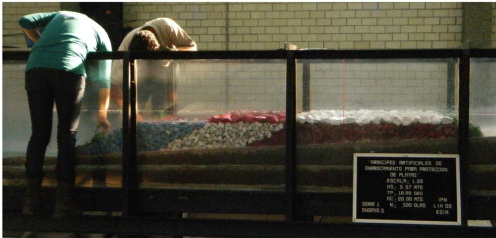
Figura 51. Colocación de los elementos de coraza para una  $B = 40$  m.
