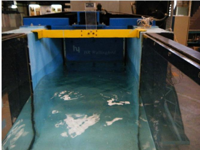
**Figura 34. Generador de oleaje HR Wallingford.**
