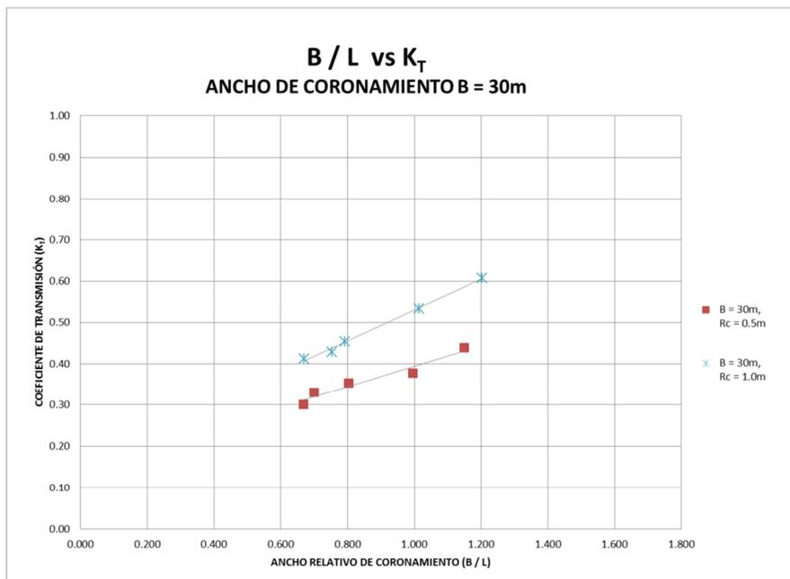
Gráfica 7. Ancho relativo de coronamiento vs  $K_T$ , para un ancho de coronamiento de 30 m.
