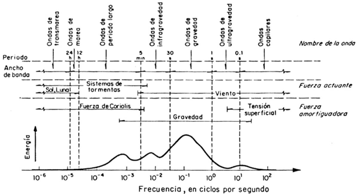
Figura 5. Clasificación del oleaje conforme al periodo, según Kinsman (1965)
