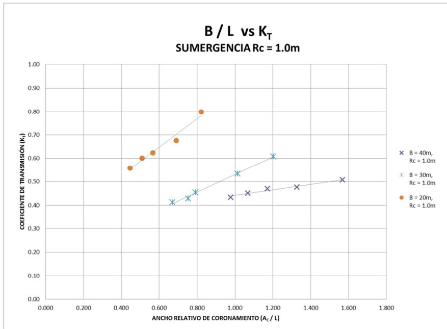
Gráfica 10. Ancho relativo de coronamiento vs  $K_T$ , para una sumergencia de 1 m.
