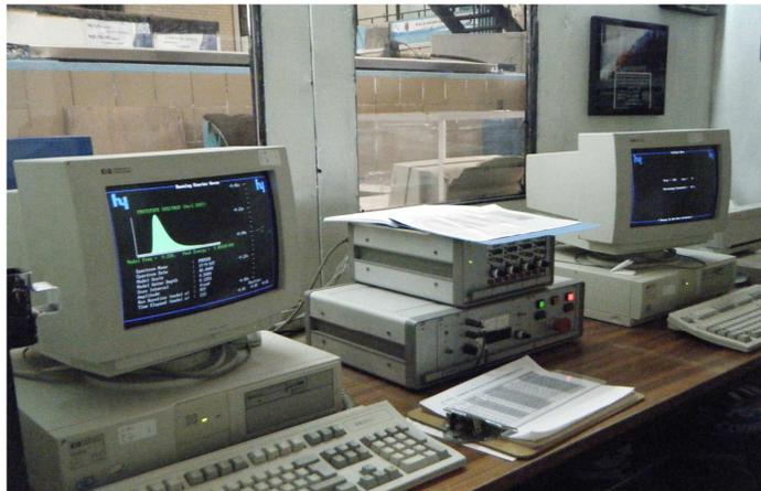
**Figura 35. Equipo de cómputo para controlar el generador de oleaje.**
