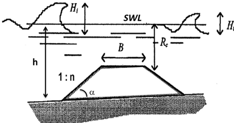
Figura 32. Parámetros de diseño en un rompeolas sumergido.
