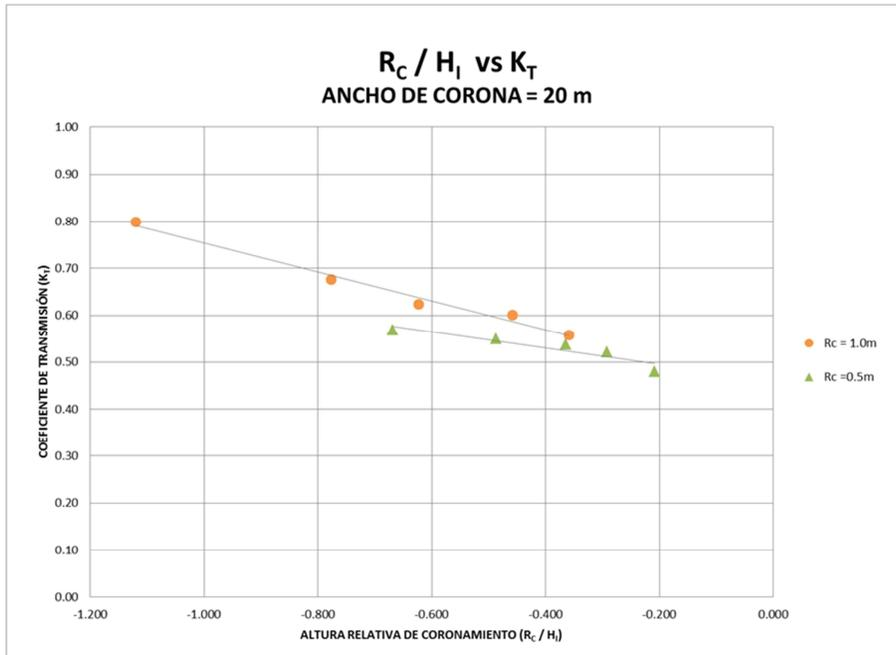
**Gráfica 1. Altura relativa de coronamiento vs  $K_T$ , para un ancho de coronamiento de 20 m.**
