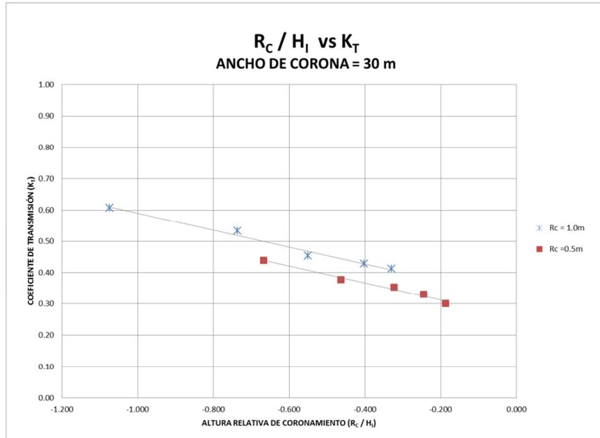
**Gráfica 2. Altura relativa de coronamiento vs  $K_t$ , para un ancho de coronamiento de 30 m.**
