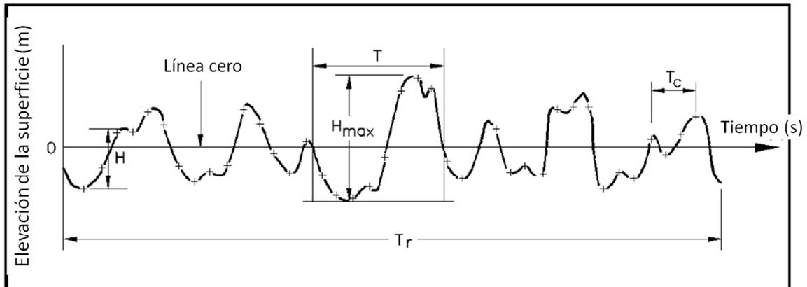
Figura 13. Parámetros del oleaje para un estado de mar aleatorio.
