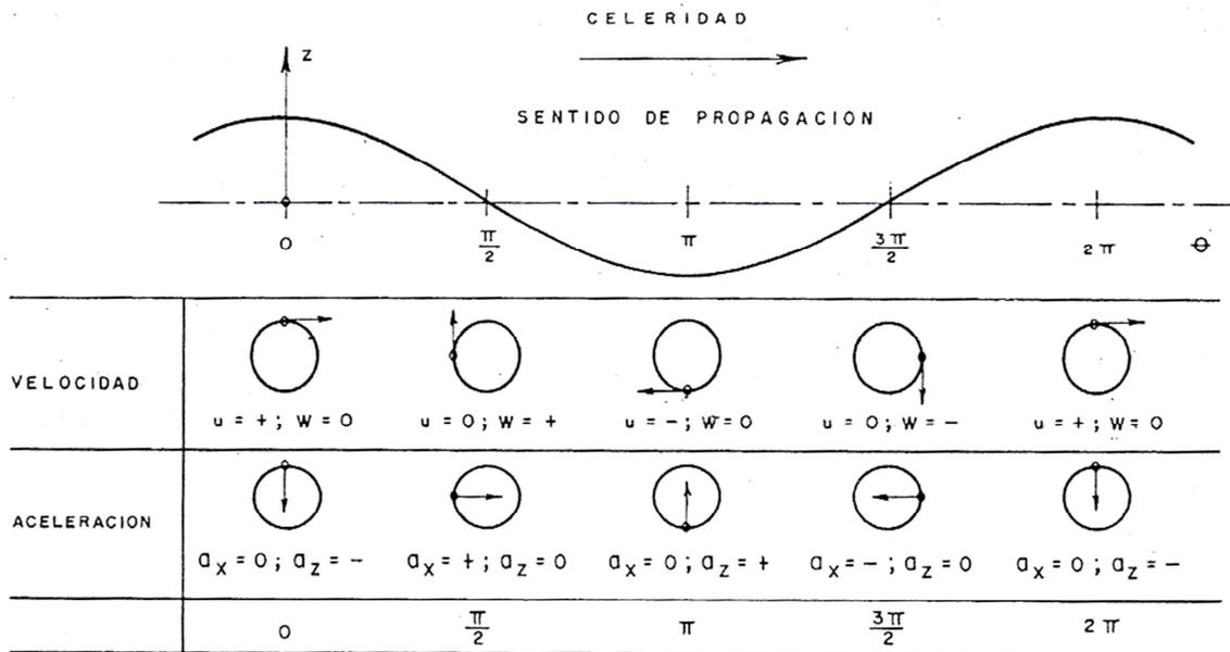
Figura 3. Esquema local de velocidades y aceleraciones. (USACE, 1984)
