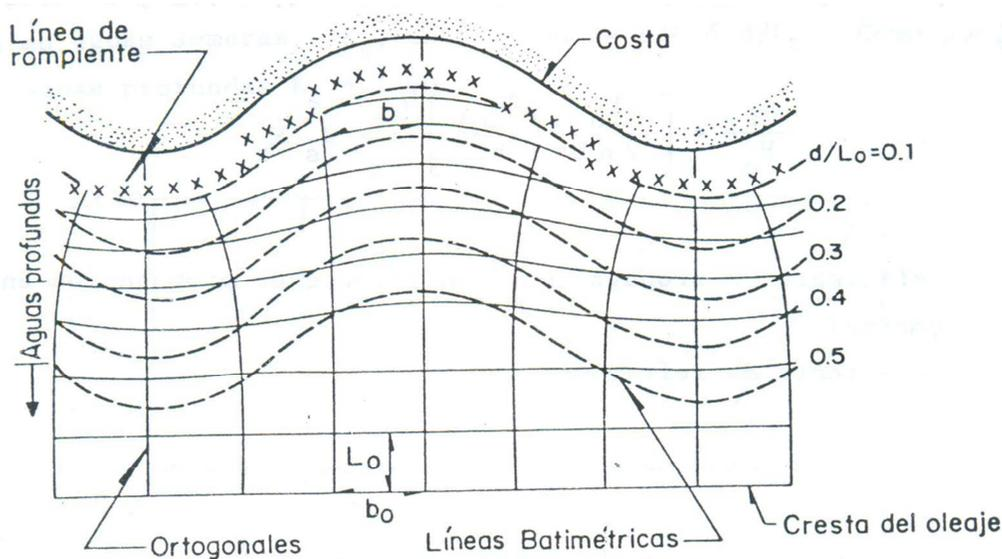
Figura 15. Refracción del oleaje. (C.F.E., 1983)
