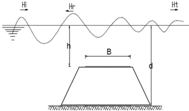
Figura 33. Transmisión del oleaje en un rompeolas sumergido.
