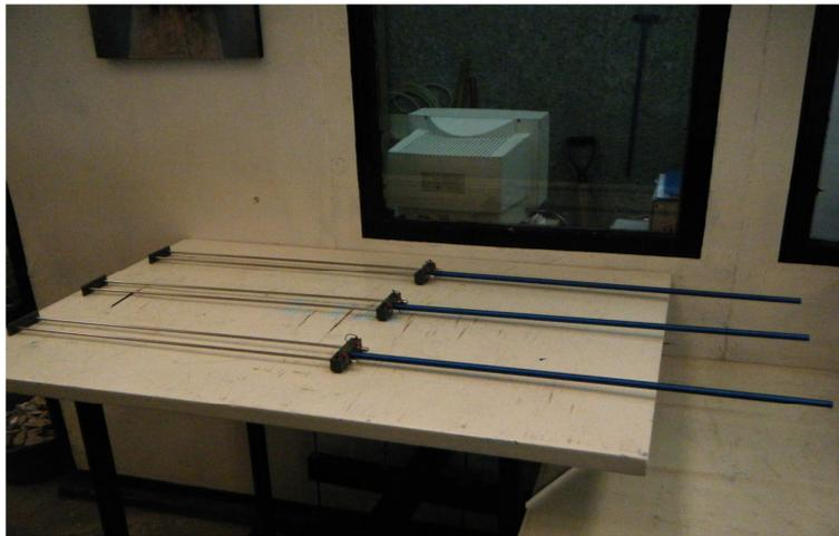
**Figura 37. Sensores de oleaje.**
