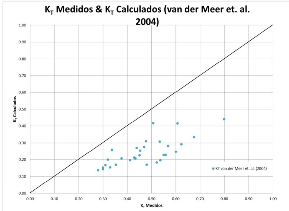
Gráfica 15. K<sub>T</sub> medidos vs K<sub>T</sub> calculados, para Van der Meer *et. al.* 2004.
