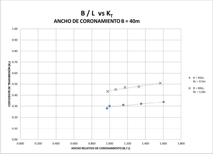
**Gráfica 8. Ancho relativo de coronamiento vs K<sub>T</sub>, para un ancho de coronamiento de 40 m.**
