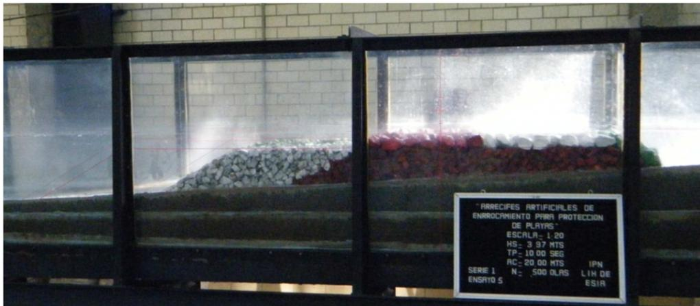
**Figura 49. Relleno de núcleo para la estructura con B = 30 m.**
