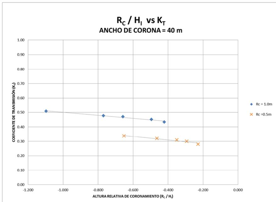
**Gráfica 3. Altura relativa de coronamiento vs  $K_t$ , para un ancho de coronamiento de 40 m.**
