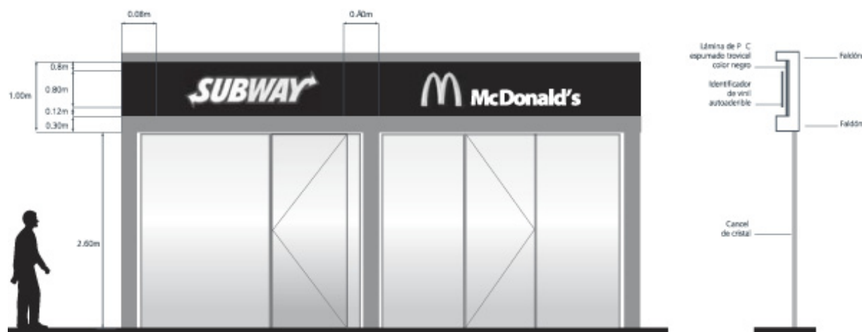
Imagen 3-6. Fachada con faldón.
