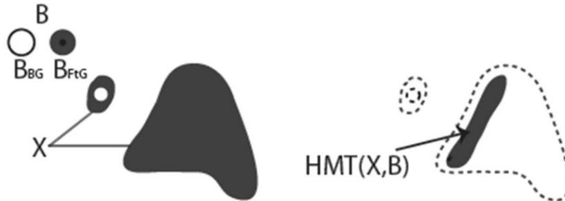
**Figura 6** Ejemplo de una transformación binaria acierta-o-falla, el EE solo puede acertar en un costado de la figura, debido a la restricción de la parte del EE perteneciente al fondo  $B_{BG}$ . Figura obtenida de [2]
