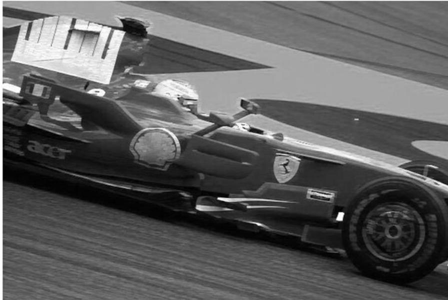
**Figura 5** Resultado de la dilatación de la misma imagen que en la Figura 7 y utilizando el mismo EE de 4x1. Por el contrario de la erosión, obsérvese el aclaramiento y desaparición de delgados detalles oscuros en comparación con la figura original.
