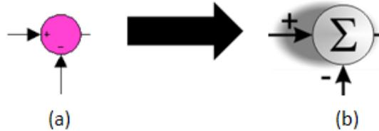
Figura 5.2 (a) Bloque del sumador en Simulink. (b) Bloque del sumador de la arquitectura básica del modulador  $\Sigma\Delta$  de primer orden.
