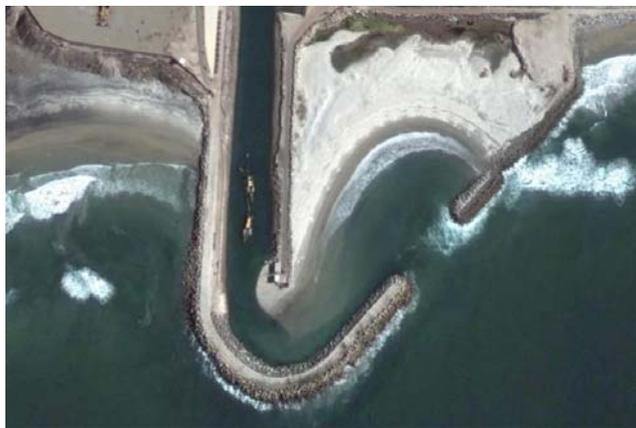
**Figuras 2.42 Obra de toma de la central termoeléctrica de Rosarito.**
