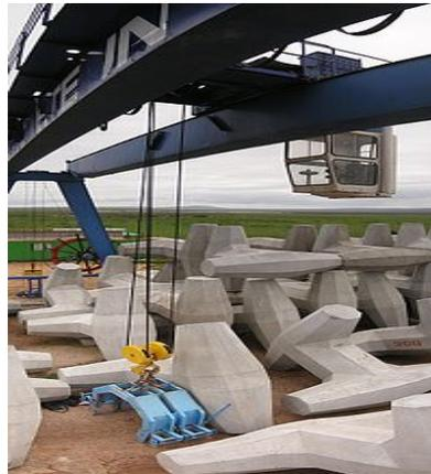
**Figura 2.10 Grúa de pórtico utilizada en patios de almacenamiento.**
