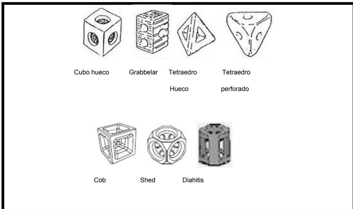
**Figura: A.13 Clasificación de las unidades multiperforadas.**
