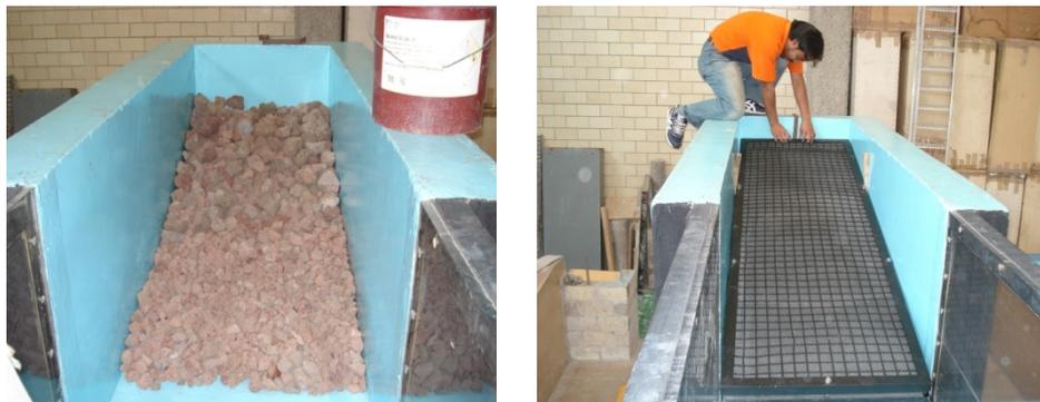
**Figura 5.10 y 5.11 Vista final de la colocación del tezontle y colocación del amortiguador de oleaje.**
