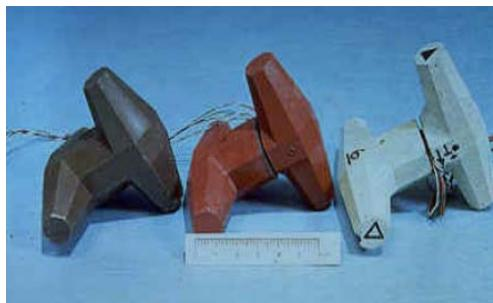
**Figura 7.1 Sensores de presión en dolos.**
