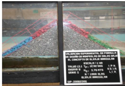
**Figura 5.20 Colocación de la roca de capa secundaria.**
