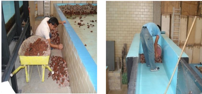
**Figuras 5.8, 5.9 Limpieza del tezontle, colocación del tezontle y vista final de la colocación.**
