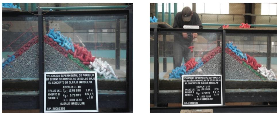
**Figura 5.21 y 5.22 Colocación de dolos.**
