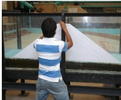
**Figura 5.15 Colocación de los escantillones sobre el acrílico del canal.**
