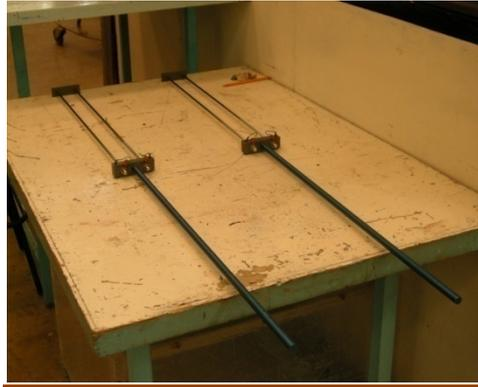
**Figura 5.5 Sensores de oleaje de tipo resistivo.**
