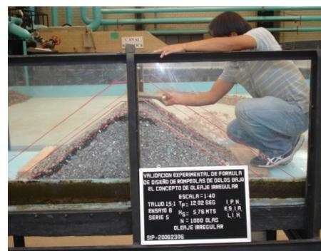
**Figuras 5.18 y 5.19** Colocación de la roca de núcleo.
