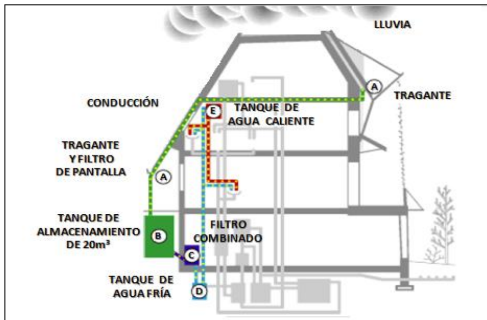
Figura 2.10 Esquema de funcionamiento del sistema de aprovechamiento de agua lluvia llamado “Healthy House” en Toronto, Canadá.
