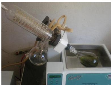
**Fotografía 3.4** Condensado de los extractos crudos al vacío.
